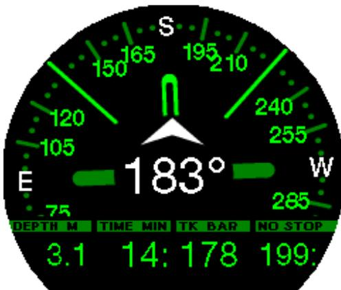
En caso de paradas de nivel o descompresión, el ángulo inferior derecho cambiará cada 4 segundos entre la información de descompresión y la presión de la botella, junto con el RBT.
