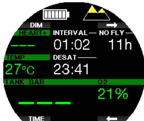
Las clases de altitud prohibidas se muestran con segmentos amarillos dentro del icono de la montaña. Pueden estar combinados con segmentos grises, que indican la altitud actual. En el ejemplo de arriba,
