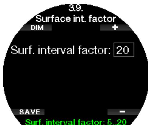
El SIF se puede ajustar de 5 a 20 o se puede desactivar seleccionando OFF.
