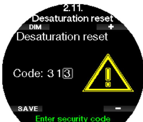
Una vez que haya introducido correctamente el código de seguridad y haya confirmado la operación pulsando el botón GUARDAR (SAVE), el restablecimiento de la desaturación finalizará y se mostrará la siguiente pantalla.
