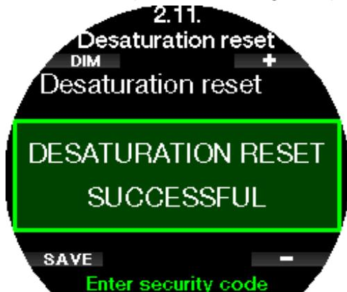
☞ *NOTA: Tras un restablecimiento de la desaturación, el cambio entre los modos Scuba, Profundímetro y Apnea será posible de inmediato. No obstante, dado que los modos Consola y Apnea no monitorizan la carga tisular de nitrógeno, se recomienda mantener los intervalos iniciales entre los cambios de modo.*
