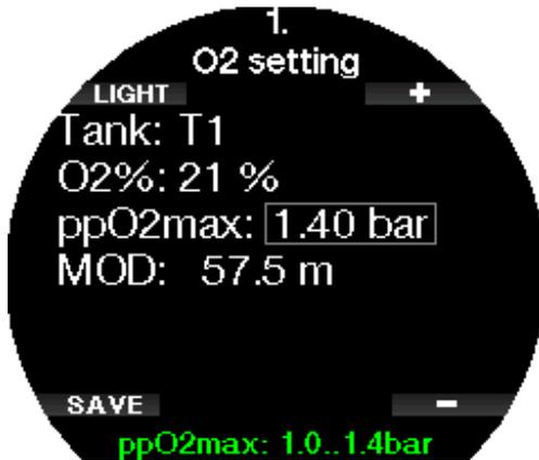
El límite de  $ppO_2$  máximo se puede modificar en el menú 2.4. **ppO<sub>2</sub>máx** (ppO<sub>2</sub>max).
