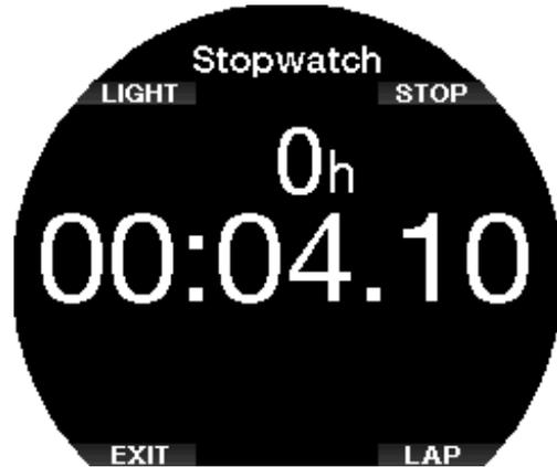
Pulsando VUELTA (LAP) puede navegar por las vueltas del cronómetro. VUELTA (LAP) solo está activo cuando el tiempo está corriendo.
