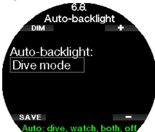
Si activa la retroiluminación automática, la pantalla quedará iluminada durante el tiempo definido en **6.3. Duración luz** (Backlight duration) cuando el usuario sacuda la muñeca y el dispositivo detecte la activación,
