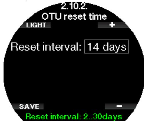
Además, si desea vaciar las OTU manualmente, puede hacerlo en el siguiente menú.
