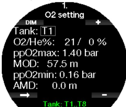
☞ **NOTA:** Para garantizar un suministro adecuado de oxígeno para el cuerpo, el gas utilizado al inicio de la inmersión debe contener suficiente oxígeno (puede utilizar una mezcla "de viaje" o uno de los gases de descompresión). Dado que la inmersión siempre comienza con la botella T1, el ajuste mínimo de  $O_2$  para la botella T1 es del 18 %.
