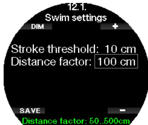
Para el contador de brazadas, debe definir el umbral de brazada (la diferencia de profundidad que se contabiliza como un ciclo de brazada, así como la distancia por ciclo o factor de distancia) para obtener los resultados adecuados.
