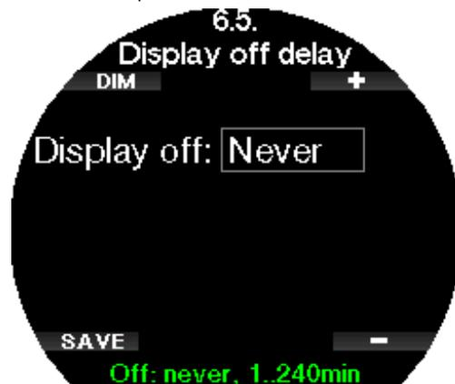
☞ **NOTA:** Si configura el tiempo de espera de la pantalla como "Nunca" (Never), la pantalla de Galileo 3 estará siempre encendida y la pila se agotará rápido.
