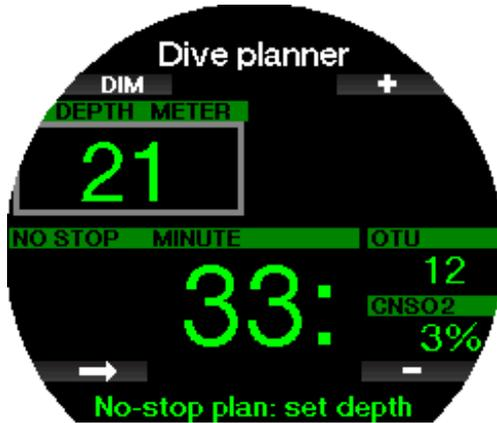
La profundidad mínima para la planificación de la inmersión es de 9 m/30 ft. El planificador solo permite profundidades en línea con la  $ppO_2$  máxima. Los valores del contenido de oxígeno y la  $ppO_2$  máxima se indican en el menú **1. Config. O<sub>2</sub>** (O<sub>2</sub> setting).
