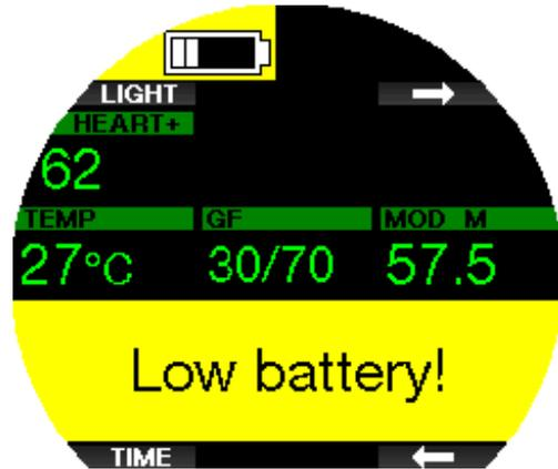
Durante la inmersión, Galileo 3 le avisa sobre el estado de carga de la batería de dos formas:
