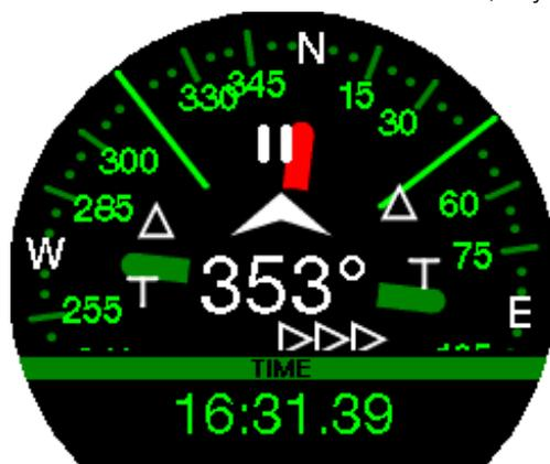
☞ **NOTA:** No use la brújula del Galileo 3 cerca de un imán, ya que la fuerza magnética puede provocar un restablecimiento de la calibración de la brújula.
