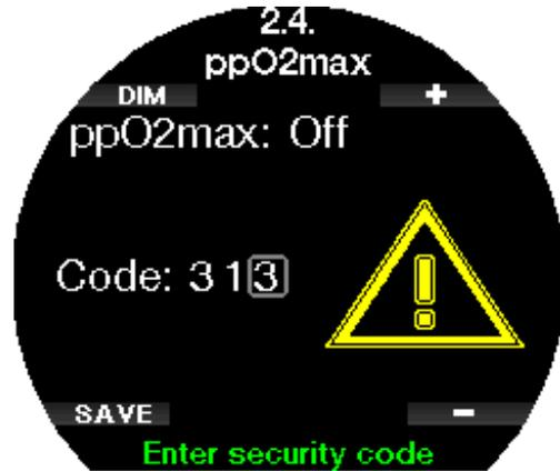
Si el ajuste de ppO<sub>2</sub>max se establece en OFF, el menú **1. Config. O<sub>2</sub>** (O<sub>2</sub> settings) se mostrará como en la pantalla de abajo.
