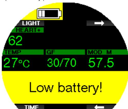
Además, el icono de la pila con el estado de carga actual se mostrará en el lado izquierdo de la pantalla principal de la esfera del reloj.
