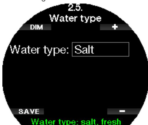
☞ **NOTA:** Este ajuste regulará la profundidad en todos los modos: Scuba, Profundímetro y Apnea.
