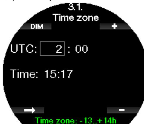
El intervalo de la configuración UTC va de -13 horas a +14 horas, con incrementos de 15 minutos.
