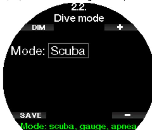
☞ *NOTA:* Dado que los modos Profundímetro y Apnea no monitorizan la saturación tisular, se produce un intervalo de bloqueo de 48 horas entre la última inmersión realizada en el modo Profundímetro o Apnea y el momento en el que ya es posible cambiar al modo Scuba. A la inversa, el Galileo 3 que se muestra a continuación ha buceado en el modo Scuba y no puede cambiar al modo Profundímetro o Apnea hasta que haya transcurrido el tiempo de desaturación.
