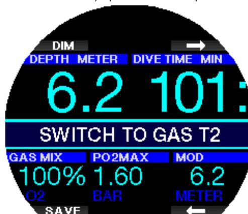
Tendrá 30 segundos para responder a este mensaje; de lo contrario, Galileo 3 considerará que el gas 2 no se va a utilizar mostrando el mensaje **EXCLUSIÓN GAS T2** (EXCLUDING GAS T2) y adaptará el plan de descompresión en consecuencia.
