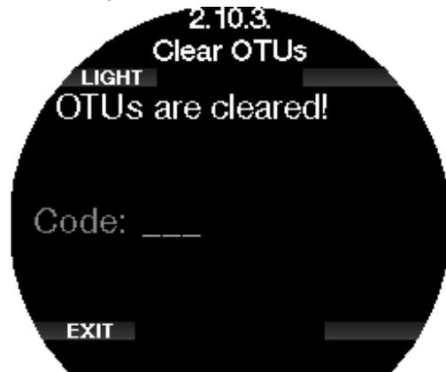
Para vaciar las OTU necesitará el código de seguridad "313".
