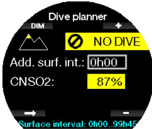
El reloj de  $O_2$  del SNC aumenta cuando la presión parcial de oxígeno es superior a 0,5 bar y disminuye cuando la presión parcial de oxígeno es inferior a 0,5 bar. Por tanto, mientras esté respirando aire en la superficie, el reloj de  $O_2$  del SNC disminuirá siempre. Durante la inmersión, la profundidad a la que se alcanzan los 0,5 bar con distintas mezclas es la siguiente:
