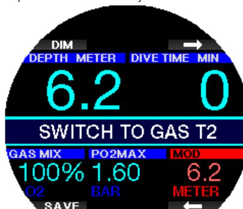
Si, por algún motivo, no cambia a la botella solicitada, Galileo 3 marcará la botella usada actualmente con un triángulo rojo debajo. El triángulo apunta a la otra botella. Esto le indica que debe cambiar a esa botella porque ha alcanzado el umbral.
