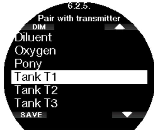
Utilice los botones de las flechas para seleccionar la botella que desee asignar al transmisor y, a continuación, pulse GUARDAR (SAVE) para guardar su selección. Galileo 3 confirmará el emparejamiento con el mensaje **SINT. BOT. T1 REALIZADA** (PAIRING TO T1 SUCCESSFUL).
