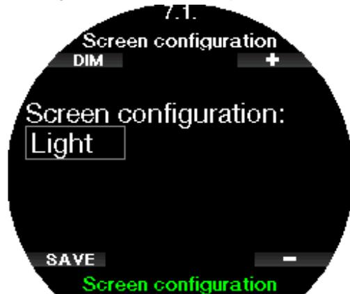
☞ **NOTA:** El diseño Ligero no admite inmersiones con paradas de nivel ni paradas de descompresión. Si ha escogido el diseño Ligero y entra en paradas de nivel o descompresión, el diseño de la pantalla cambiará a Clásico hasta que haya cumplido todas las obligaciones de paradas de nivel o descompresión.
