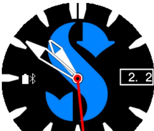
Abra la app LogTRAK en su iPhone®, vaya al menú **10. Bluetooth** en Galileo 3 y establezca la conexión. Introduzca el código pin que se muestra en la pantalla de Galileo 3.
