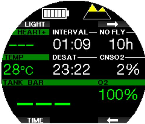
Las altitudes permitidas se muestran con el símbolo de una montaña en el ángulo superior derecho de la pantalla de los ajustes actuales de la inmersión. Las altitudes no permitidas (las altitudes que Galileo 3 ha calculado como incompatibles con sus niveles actuales de saturación de nitrógeno) se muestran
