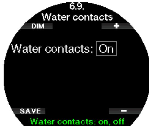
☞ **NOTA:** Si los contactos de agua están desactivados y olvida encender el ordenador manualmente, el ordenador se activará automáticamente de todas formas al cabo de un minuto desde el inicio de la inmersión. Como consecuencia, los cálculos de tiempo y descompresión serán poco precisos, pero la precisión de la medición de la profundidad no se verá comprometida.
