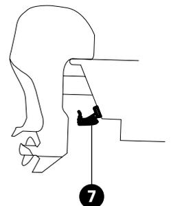
**Vue dégagée :** La plaque de la prise donne au transducteur une distance sécurisée loin du moteur et de ses turbulences. L'imagerie latérale dispose d'une vue dégagée d'un côté à l'autre.
