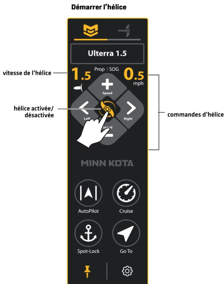
Utilisez les instructions suivantes pour démarrer/arrêter l'hélice manuellement à l'aide de la télécommande numérique de moteur de pêche à la traîne sur le détecteur de poissons.
