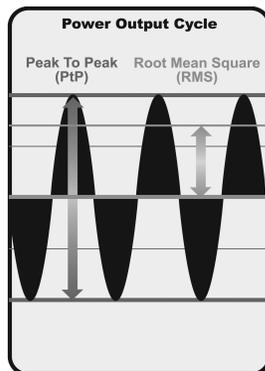
La puissance de sortie est la quantité d'énergie produite par l'émetteur sonar. Elle est généralement mesurée en utilisant deux méthodes :
