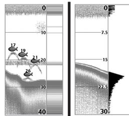
La fenêtre sonar en temps réel large indique l'intensité sonar à l'aide d'un diagramme à barres. La longueur des retours reportés fournit une indication quant à l'intensité du retour. La profondeur du retour sonar est indiquée par l'emplacement vertical du retour sur l'échelle de profondeur de l'écran.
