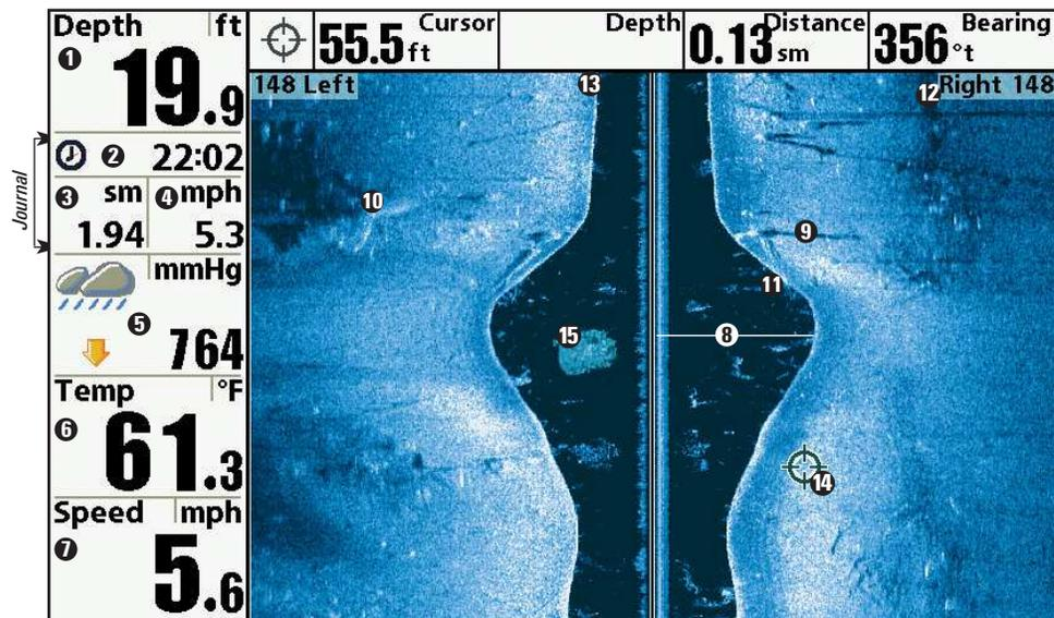
7 **Vitesse** - Si le capteur de vitesse ou le récepteur GPS est installé, le système peut afficher la vitesse du bateau et aussi maintenir un compteur des milles nautiques ou terrestres parcourus.
