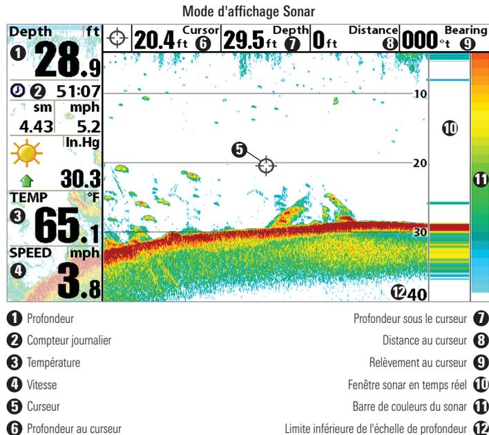
**REMARQUE :** Si l'indicateur de profondeur clignote, cela signifie que l'appareil a des difficultés à localiser le fond. Ceci se produit habituellement lorsque le transducteur est hors de l'eau, lorsque le bateau est en eau trop profonde, lorsqu'il se déplace trop rapidement, ou lors de tout autre événement empêchant l'appareil de recevoir des données continues.
