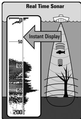
Le terme SONAR est un acronyme de l'expression anglaise « Sound and Navigation Ranging ». La technologie sonar utilise des pulsations sonores précises (appelées « impulsions ») émises dans l'eau dans un faisceau ayant la forme d'une goutte d'eau.
