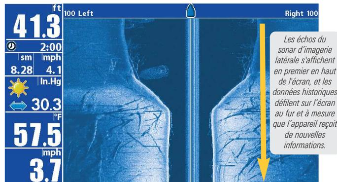
L'avantage principal du sonar d'imagerie latérale pour les pêcheurs à la ligne est qu'il fournit un balayage général d'une grande zone. Le pêcheur a donc une meilleure compréhension de la topographie de la zone et de l'orientation de la structure, ce qui lui permet de pêcher de façon plus efficace.
