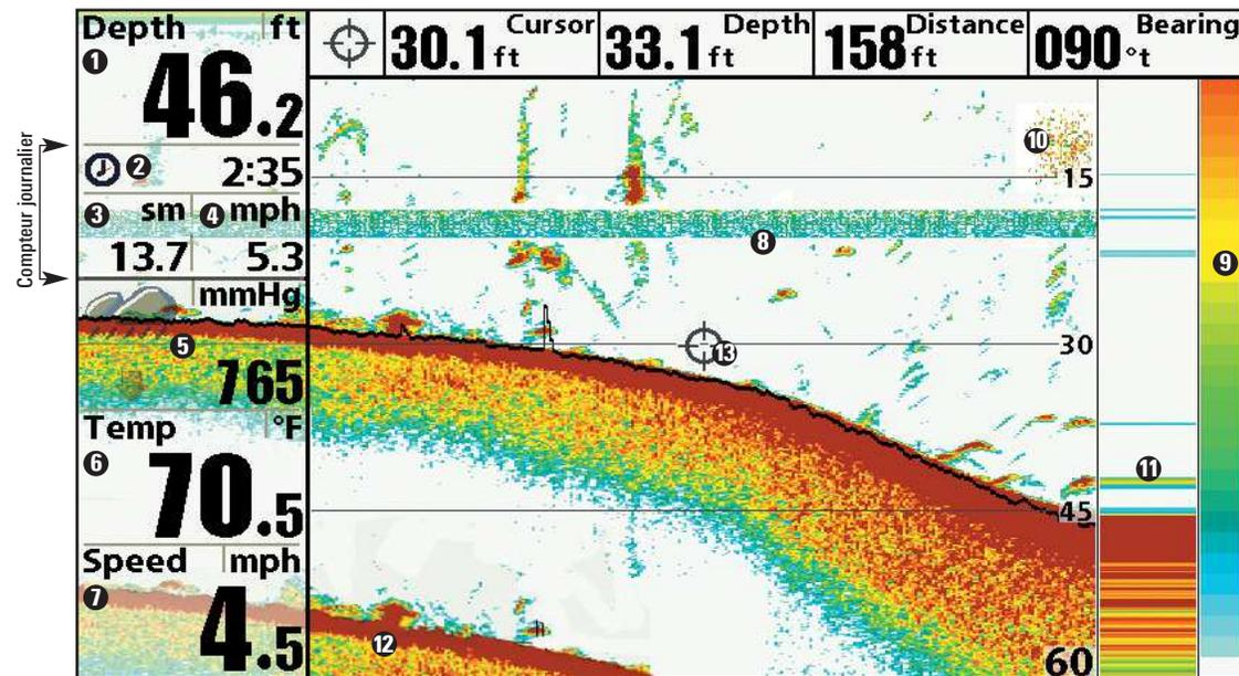
**8** Thermoclines - Couches d'eau de température différente situées à des profondeurs différentes, selon la période de l'année. Généralement, une thermocline apparaîtra comme une bande continue composée de plusieurs couleurs, se déplaçant sur l'écran à la même profondeur.
