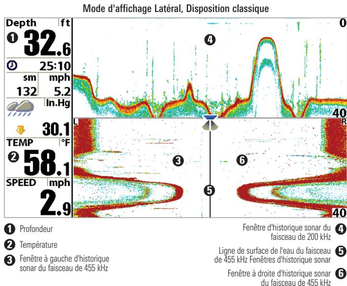
**Disposition oblique :** Cette disposition montre les deux faisceaux latéraux de 455 kHz et le faisceau orienté vers le bas de 200 kHz sous forme de trois tableaux de données historiques. Cette disposition est représentée sous forme de trois tableaux obliques. Toute nouvelle information s'affiche à droite et défile vers la gauche.
