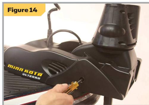
2. À l'aide d'un tournevis à lame plate, soulever sur le bouton d'inclinaison manuel jusqu'à ce qu'il libère les plaques métalliques. (Figure 15 and Figure 16)
