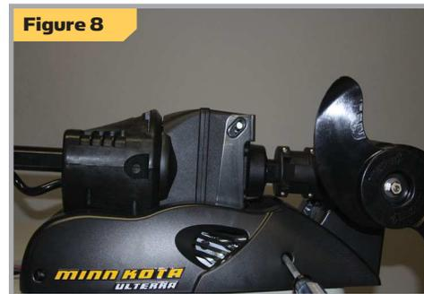
7. Replacer les plaques latérales et les vis de plaques latérales à la main. (Figure 8). **REMARQUE:** Ne pas utiliser un outil électrique à installer ces vis.
