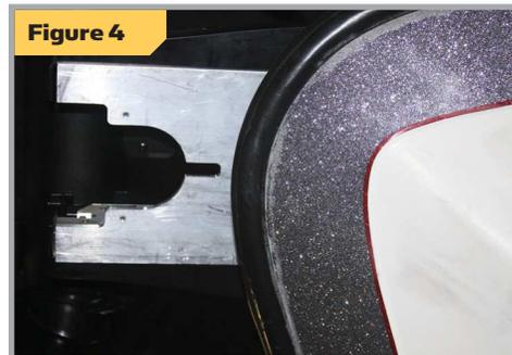
4. Une fois que le moteur est en position, marquer un minimum de quatre des six trous de montage qui se trouvent plus éloignés. Percer les trous aux endroits marqués à l'aide d'une mèche de 5/16 po (6,25 mm).
