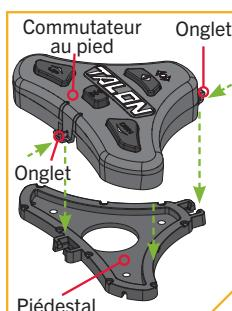
**AVIS :** Le piédestal est attaché au commutateur au pied et doit être retiré pour l'installation.
