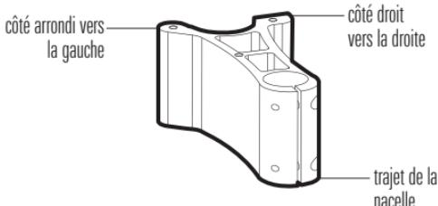
4. Installer les 3 vis (1/4 - 20, 1 po) sur les trous filetés du support conformément à l'illustration. Ne pas serrer complètement.
