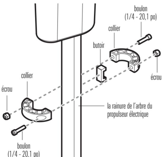
5. Utiliser une clé hexagonale (non comprise) pour serrer la quincaillerie juste assez pour maintenir le collier de serrage assemblé.
