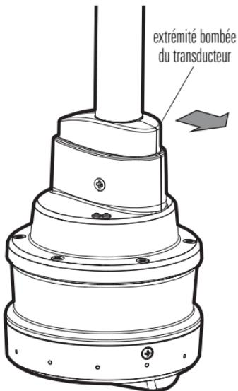
4. Une fois le transducteur en bonne position, serrer entièrement les boulons (uniformément et complètement) à la main afin que l'arbre de la nacelle soit bien fixé et pour d'éviter toute chute ou déplacement non souhaité de la nacelle durant son opération. Serrer chaque boulon d'un 1/4 ou 1/2 tour supplémentaire. **Les serrer à la main seulement !**
