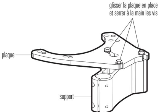
7. Serrer les vis à la main à l'aide d'une clé à douilles 3/8 po. **Les serrer à la main seulement !**
