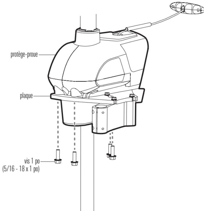
2b. **Ultrex QUEST** : Installez les (2) vis 5/16-18 x 2" à travers la plaque et les entretoises et à l'avant du BowGuard. Installez les (2) vis 5/16-18 x 1" à travers la plaque et dans le arrière du BowGuard. Serrez à la main à l'aide d'une clé ou d'une douille de 1/2" jusqu'à ce qu'elle soit bien fixée (voir l'illustration *Installation du support sur l'Ultrex Quest*). Serrez à la main uniquement !
