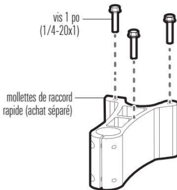
5. Aligner le trou central de la plaque sur la vis gauche (installation sur le côté gauche) ou la vis droite (installation sur le côté droit).
