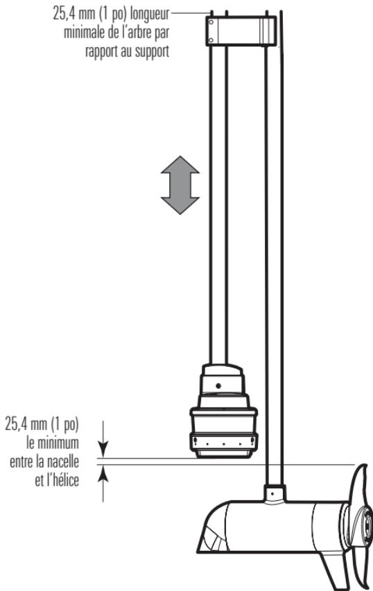
3. Faire pivoter l'arbre de la nacelle jusqu'à ce que l'extrémité bombée du transducteur pointe en direction du déplacement. L'axe central du transducteur devrait être parallèle à l'axe central de l'embarcation. Voir l'illustration intitulée **Alignement du transducteur**.
