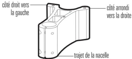
**Si le propulseur électrique se déploie à bâbord (gauche) sur la proue, le support sera monté sur le côté droit du moteur électrique. Positionnez le support de manière à ce que la règle soit orientée vers la droite, comme indiqué sur l'illustration.**
