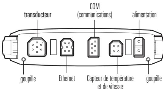
4. **Alimentation** : Acheminez le câble d'alimentation à l'interrupteur principal ou au tableau à fusibles (habituellement situé proche de la console). Si vous devez vous brancher à une batterie, branchez-vous à un interrupteur batterie (vendu séparément).
