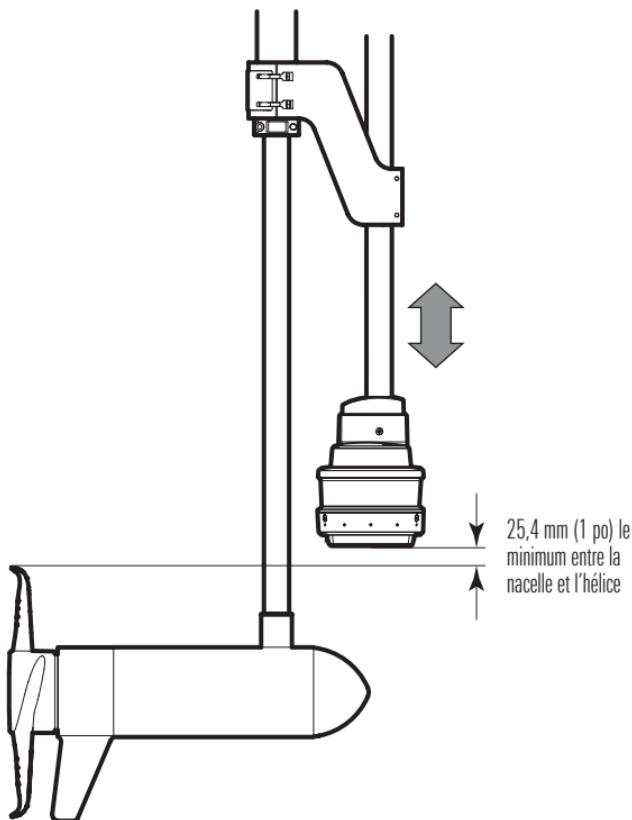
4. Faire pivoter le support jusqu'à ce que la nacelle soit à 50,8 mm (2 po) de la base de la poignée d'assistance et à 13 mm (1/2 po) de l'arbre du propulseur électrique. Voir l'illustration intitulée **Calcul de la distance de la nacelle** et **Positionnement du support**.
