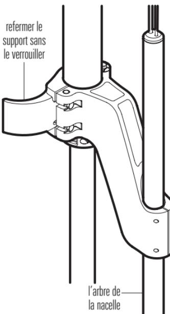
3. Régler l'arbre de la nacelle afin que celle-ci soit à au moins 25,4 mm (1 po) du bout de l'hélice.
