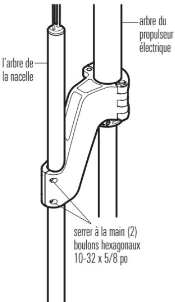
8. Faire pivoter l'arbre de la nacelle jusqu'à ce que l'extrémité bombée du transducteur pointe en direction du déplacement. L'axe central du transducteur devrait être parallèle à l'axe central de l'embarcation. Voir l'illustration intitulée **Alignement du transducteur**.
