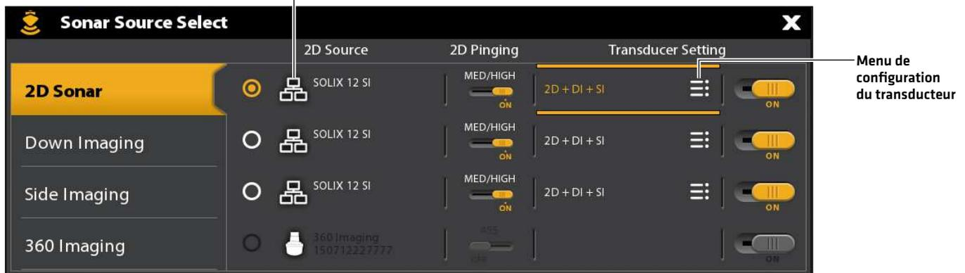
6. **Capacités du sonar** : sur le menu de configuration du transducteur, cochez en regard de chaque capacité de sonar pour le transducteur sélectionné.
