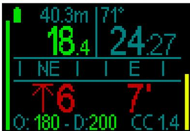
Das Beispiel der Anzeige zeigt SP2 auf der unteren Zeile rechts und den Sauerstoff/ Diluent auf der unteren Zeile links.
