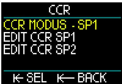
In diesem Untermenü kannst du deine Setpoints (während des Tauchgangs bearbeitbar) voreinstellen und auswählen, ob du mit Setpoint 1, Setpoint 2 oder einem Bailout-Gas starten möchtest.
