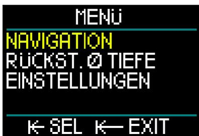
Während eines Tauchgangs im Tiefenmesser-Modus zeigt der HUD oben links die durchschnittliche Tiefe an. Diese kann im Menü Einstellungen unter Rückst. Ø Tiefe zurückgesetzt werden.
