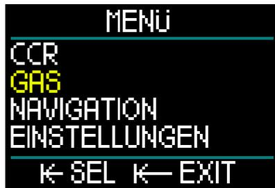
Nachdem die Gastabelle mit OC-Gasen eingerichtet wurde, kannst du während eines CCR-Tauchgangs zu OC wechseln. Dabei wird das erste OC-Gas in der Gastabelle aktiviert. Die Verwendung ist identisch wie im SCUBA Modus.
