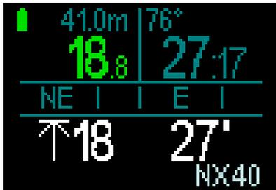
Während der Aufstiegsphase wird Ihnen HUD bei Erreichen der MOD eines Gases auf der entsprechenden Tiefe empfehlen, den Wechsel durchzuführen. Das vorgeschlagene Gas blinkt unten rechts weiß. Du hast 20 Sekunden Zeit auf diese Meldung zu reagieren und den Wechsel durchzuführen; andernfalls wird der HUD den Gaswechsel nicht mehr vorschlagen und wird die Dekompressionsverpflichtungen und die TAT neu berechnen. Wenn du das Gas später verwenden willst, musst du es manuell aktivieren.
