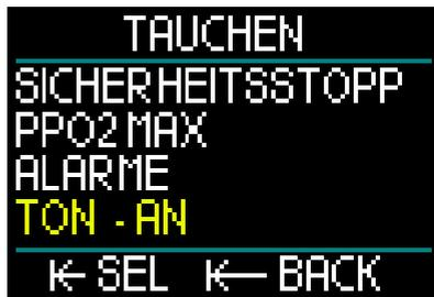
Durch Auswählen von Ton im Menü Taucheinstellungen und Drücken-und-loslassen der Radtaste wird das Menü zum aktivieren und deaktivieren des Tons geöffnet.
