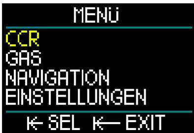
Durch Auswählen von CCR und Drücken und Loslassen der Radtaste gelangst du in das Untermenü der CCR Einstellungen.
