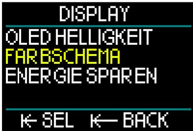
Blättere auf dem Menü Display zum Menü Farbschema und öffne es durch Drücken-und-Loslassen der Radtaste. Hier stehen vier verschiedene Farbschemata zur Auswahl, die du entsprechend dem Umgebungslicht deines Tauchgangs auswählen kannst.
