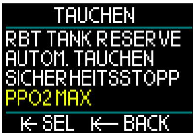
Durch Auswählen von  $ppO_2$  max im Menü Taucheinstellungen und Drücken-und-loslassen der Radtaste wird die Anzeige zum Einstellen von  $ppO_2$  max geöffnet.
