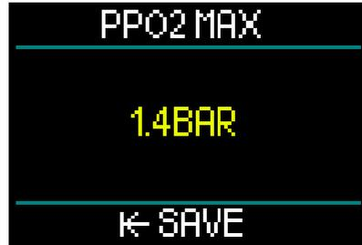
Die  $ppO_2$  max Einstellungen bestimmen die Grenze für den Sauerstoffeildruck. Die Grenze ist für alle Gase gleich. Der HUD ermöglicht  $ppO_2$  max Einstellungen von 1,3 bar bis 1,6 bar (Werkeinstellung 1,4 bar).
