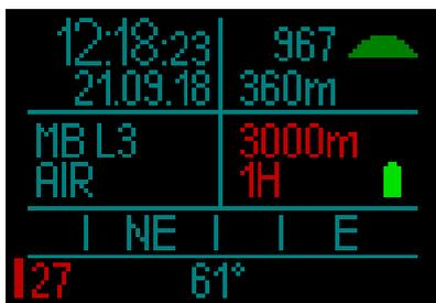
Die maximal erlaubte Höhe (die der HUD basierend auf deiner aktuellen Stickstoffsättigung als inkompatibel mit deiner aktuellen Stickstoffsättigung berechnet hat) wird über der Flugverbotszeit in Rot angezeigt. Die aktuelle Höhe kann im Menü überprüft werden. Siehe Kapitel: **Einstellungen / Höhenmesser**.
