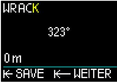
Wiederhole dieses Verfahren mit jedem hervorgehobenen Buchstaben, bis du den neuen Namen der Peilung fertig geschrieben hast und speichere durch Drücken-und-halten. Dadurch gelangst du zur Tiefeneinstellung.
