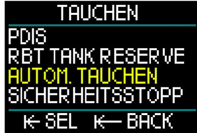
Wenn du AUTO wählst, schaltet sich dein HUD automatisch ein, wenn der Drucksensor Wasserdruck erkennt.
