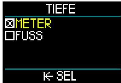
Im Menü Tiefe, wähle mit der Radtaste entweder Meter oder Fuß. Nach dem Speichern der Auswahl durch Drücken-und-loslassen kehre zum Menü Einheiten zurück. Im Menü Einheiten drehe die Radtaste weiter zu Temperatur. Drücken und loslassen.
