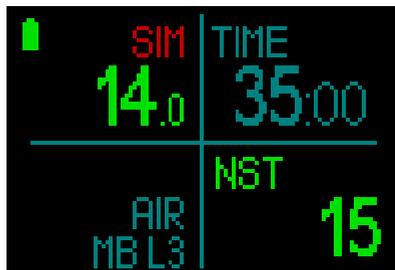
Wenn du einen Tauchgang mit verbleibender Gewebesättigung im Körper und in deinem HUD planst, wird der Planer den Tauchgang basierend auf deinem aktuellen Status beim Aktivieren des Planers berechnen.
