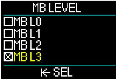
Hier kannst du den bevorzugten Mikroblasen (MB) Level von 0 bis 5 einstellen, den du für deine Tauchgänge willst. Level 0 ist der am wenigsten konservative Level. Level 5 ist der konservativste Level.
