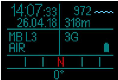
Nach dem Trennen des Ladekabels wechselt das Batteriesymbol auf grün.
