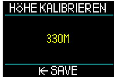
Im Menü Höhe wird die aktuelle Höhe anhand des Barometerdrucks berechnet. Die Höhe kann eingestellt werden, wenn die aktuelle Höhe bekannt ist, indem man mit der Radtaste nach oben oder unten blättert. (Die Einstellung der Höhe hat keinen Einfluss auf den Tauchgang.)
