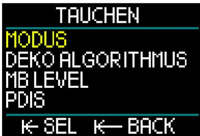
Durch Auswählen von Modus im Hauptmenü und Drücken-und-loslassen der Radtaste wird die Anzeige Modus geöffnet.
