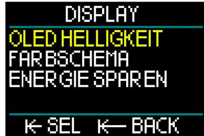
Wähle im Menü Display OLED Helligkeit und öffne das Menü durch Drücken-und-loslassen.
