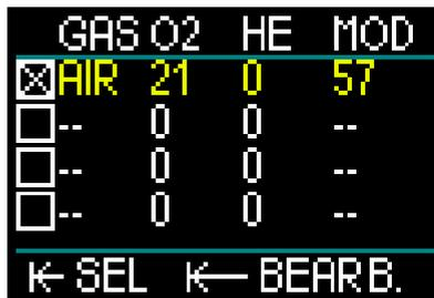
Mit HUD kannst du bis zu 8 Gase programmieren oder bearbeiten. Wenn du deine Sauerstoff- und Heliumanteile eingibst, wird automatisch für die ausgewählten Werte die Maximale Tiefe
