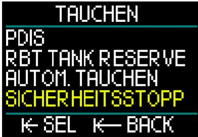
Durch Auswählen von Sicherheitsstopp im Menü Taucheinstellungen und Drücken-und-loslassen der Radtaste wird die Anzeige zum aktivieren und deaktivieren des Sicherheitsstopp-Timers geöffnet.
