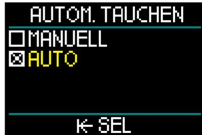
Bei der MANUELLEN Einstellung musst du die Radtaste drücken und halten, um die Einheit einzuschalten. Diese Funktion erlaubt es dir, jegliche unerwarteten Lichtemissionen vom Bildschirm zu verhindern, wenn du ins Wasser gehst.
