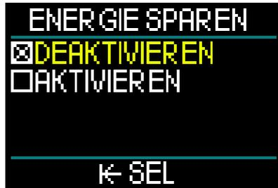
Um während eines Tauchgangs Batterieladung zu sparen, kannst du den Modus Energie sparen aktivieren.
