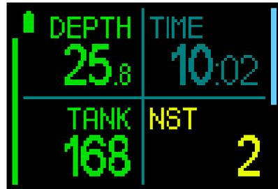
Dies gilt sowohl für L0-Nullzeit wie auch für die MB-Nullzeit (siehe Kapitel: Tauchen mit MB-Levels für mehr Informationen über das MB-Level-Tauchen). Dadurch wird ermöglicht, den Aufstieg zu beginnen, bevor ein Dekompressionsstopp erforderlich wird. Wenn die Nullzeit 0 erreicht und abgelaufen ist, ändert die Farbe auf rot.
