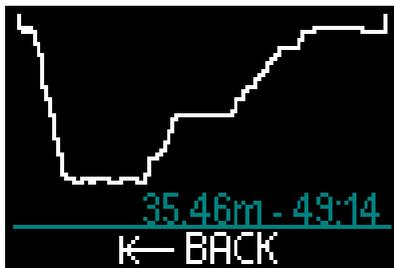
Einmaliges Drücken-und-loslassen der Radtaste bringt dich auf das Profildisplay und zeigt das Profil des Tauchgangs zusammen mit der Tiefe und der gesamten Tauchzeit. Durch Drücken-und-loslassen der Radtaste verlässt du die Profilanzeige.
