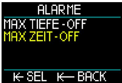
Durch Drehen der Radtaste kann der Wert der maximalen Zeitwarnung in Schritten von 1 Minuten. zwischen 1 und 995 Minuten eingestellt werden. Drücken-und-loslassen der Radtaste, um den eingestellten Wert zu speichern und den Alarm zu aktivieren. Um den Alarm für die maximale Tauchzeit zu deaktivieren, drücke und halte die Radtaste.
