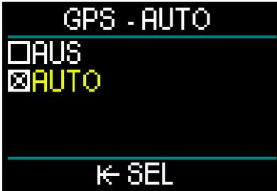
Im Modus GPS AUTO kannst du durch Drehen der Radtaste auf der Oberflächenanzeige die aktuelle Zeit, das Datum sowie deine GPS-Koordinaten sehen. Zudem wird die Richtung (TH) zum derzeit eingestellten Wegpunkt und die Gesamtdistanz (TD) zu diesem Wegpunkt angezeigt.
