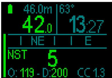
Das Beispiel der Anzeige zeigt SP1 auf der unteren Zeile rechts und den Sauerstoff/ Diluent auf der unteren Zeile links.
