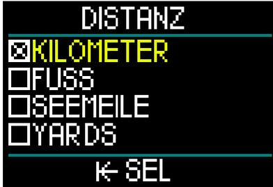
Im Menü Distanz gibt es 4 Auswahlmöglichkeiten zum Messen der horizontalen Distanz. Drehe die Radtaste zum Auswählen. Nach dem Speichern der Auswahl durch Drücken-und-loslassen kehre zum Menü Einheiten zurück.
