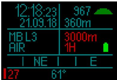
Die aktuelle Höhe wird oben rechts zusammen mit einem Symbol angezeigt. Die Flugverbotszeit wird in Rot angezeigt. Darüber ist die maximal erlaubte Höhe (die der HUD basierend auf deiner aktuellen Stickstoffsättigung berechnet hat) auch in Rot angezeigt.
