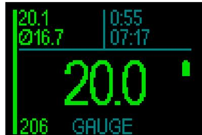
Durch Drehen an der Radtaste kannst du zur Profilanzeige wechseln.
