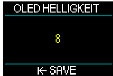
Durch Drehen der Radtaste kannst du die Anzeigehelligkeit von 0 (dunkelste) bis 10 (hellste) deinen Bedürfnissen anpassen.
