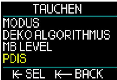
Durch Auswählen der Taucheinstellungen im Hauptmenü und Drücken-und-loslassen der Radtaste wird die Anzeige zum Aktivieren der profilabhängigen Zwischenstopps geöffnet.
