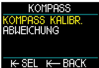
Die erste Auswahl auf dem Menüs Kompass ist „Kompass Kalibr“ oder Kalibrierung. Drücken-und-loslassen der Radtaste öffnet das Verfahren zur Kalibrierung.
