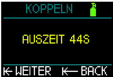
8. Während der Countdown-Timer zählt, öffne das Flaschenventil. Nachdem der Smart-Sender unter Druck gesetzt wurde, sendet er eine Kopplungssequenz an HUD.
