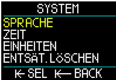
Durch Drehen der Radtaste kannst du zu den folgenden Untermenüs gelangen. Durch Drücken-und-Loslassen der Radtaste öffne das ausgewählte Untermenü.
