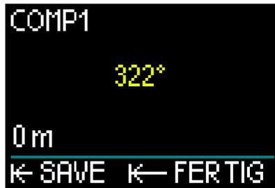
Weisen du mit dem HUD in die Richtung, in die du schwimmen/tauchen möchtest. Durch Drücken-und-loslassen wird die Peilung gespeichert.
