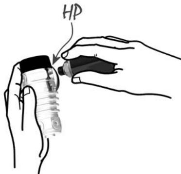
**☞ HINWEIS:** Schraube den Sender mit den Händen in den Hochdruckanschluss der ersten Stufe und ziehe ihn mit einem geeigneten Schraubenschlüssel fest. Sei vorsichtig, ihn nicht zu überdrehen.
