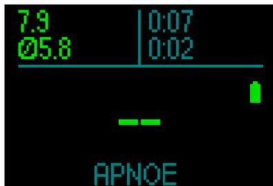
Nach 15 Minuten an der Oberfläche wird eine Tauchserie als abgeschlossen erachtet und ein Logbucheintrag erstellt. Der nächste Tauchgang wird im nächsten Logbucheintrag gespeichert.
