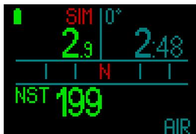
Das rote Symbol SIM oben auf dem Display zeigt an, dass du im Simulationsmodus bist.
