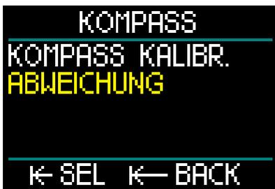
Ein Kompass zeigt auf den magnetischen Nordpol der Erde. Die Abweichung unserer geografischen Position im Verhältnis zum magnetischen Nordpol erfolgt durch die Einstellung der Deklination.
