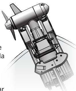
L'orientation au rangement est la direction dans laquelle l'unité inférieure repose sur le support lorsqu'elle est rangée. Configurez-la à hélice à droite ou à gauche (par défaut) depuis l'application One-Boat Network ou par la télécommande sans fil.
