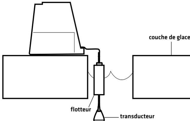
**REMARQUE :** Le transducteur doit être submergé dans l'eau pour la fiabilité de la détection. La partie inférieure du transducteur doit être à niveau avec le dessous de la couche de glace ou pendre légèrement en dessous du fond de la couche de glace.
