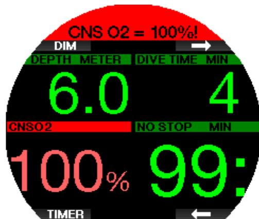
Das akustische Signal erklingt während 5 Sekunden in Intervallen von 1 Minute nach dem ersten Auftreten, und solange ZNS O<sub>2</sub> bei 100 % oder höher ist oder bis  $ppO_2$  unter 0,5 bar fällt (siehe Kapitel **Tauchen mit Nitrox oder einem anderen Dekompressionsgas** für eine Liste von Tiefen, auf denen auf der  $ppO_2$  für häufig verwendete Nitrox-Gemische 0,5 bar beträgt).
