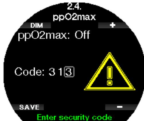
Wenn die ppO<sub>2</sub>max-Einstellung auf AUS (OFF) gesetzt ist, erscheint das Menü **1. O<sub>2</sub>-Einstellungen** (O<sub>2</sub> settings) werden wie das folgende Display angezeigt.
