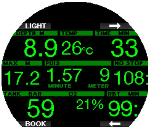
Die PDIS-Tiefe erscheint im mittleren Fenster. Bei einem Nullzeittauchgang wird, sobald du während eines Aufstiegs diese Tiefe erreichst, ein 2 Minuten dauernder Countdown angezeigt. Eine von 3 Situationen tritt hierbei auf:
