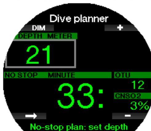
Die Mindesttiefe für den Tauchplan beträgt 9 m. Der Tauchplan erlaubt nur Tiefen in Übereinstimmung mit dem maximalen ppO<sub>2</sub>. Der Sauerstoffgehalt und die Einstellungen des maximalen ppO<sub>2</sub> befinden sich in Menü **1. O<sub>2</sub>-Einstellung** (O<sub>2</sub> setting).
