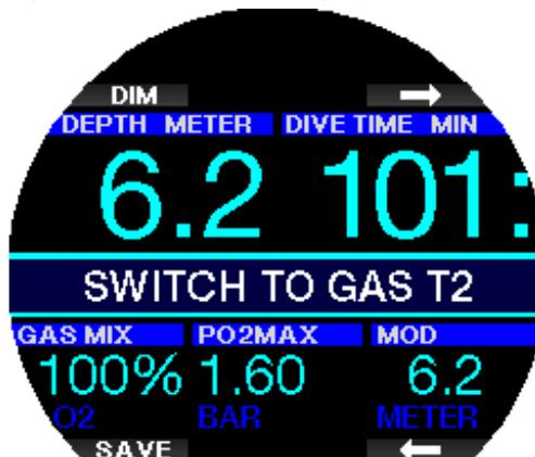
Du hast 30 Sekunden lang Zeit, um auf diese Meldung zu reagieren. Anderenfalls geht der Galileo 3 davon aus, dass Gas 2 nicht verwendet wird und zeigt die Meldung **(GAS T2 ENTFERNT (EXCLUDING GAS T2))** an und passt die Dekompressionsstufen entsprechend an.
