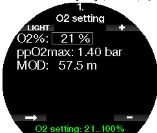
In diesem Fall sind die Funktionen der oberen und unteren rechten Taste mit - und + gekennzeichnet (um die aktuelle Auswahl zu bearbeiten). Die untere linke Pfeiltaste verschiebt deine Auswahl auf das nächste Feld und SPEICHERN (SAVE) speichert die eingegebenen Werte.
