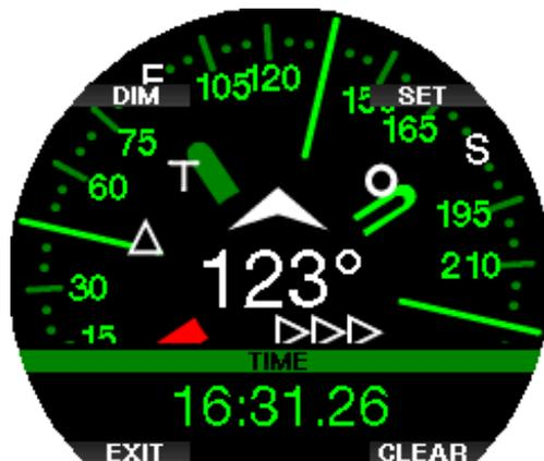
Wenn du eine Referenzpeilung eingestellt hast, erscheinen links oder rechts der numerischen Peilungsanzeige Pfeile, die dir die Richtung anzeigen, in die du dich drehen musst, um mit der Peilung ausgerichtet zu sein. Als zusätzliche Navigationshilfe markiert Galileo 3 automatisch die Positionen bei 90 und 120 Grad links und rechts der eingestellten Peilung sowie die Position bei 180 Grad (als Hilfe für einen Quadratkurs, Dreieckkurs und Umkehrkurs). Diese werden mit „T“, Δ und || bezeichnet.
