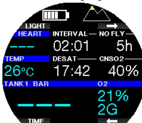
Der ZNS  $O_2$ -Wert nach einem Tauchgang kann im Menü **9. Tauchgangplaner** (Dive Planner) angezeigt. Dort wird der aktuelle Wert angezeigt, wenn Add surf. int. 0 h ist.
