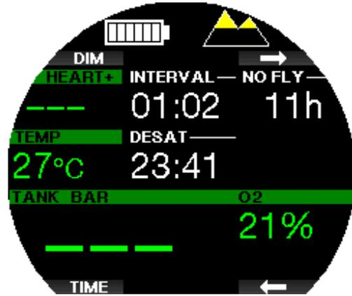
Die verbotenen Höhenbereiche werden durch gelbe Segmente innerhalb des Bergsymbol an angezeigt. Diese können kombiniert mit den grauen Segmenten des aktuellen Höhenbereichs angezeigt werden. Im oben Beispiel befindet sich der Taucher auf Höhenbereich 1 und darf den Höhenbereich 4 nicht erreichen oder übersteigen.
