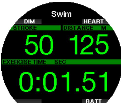
Wenn du BATT drückst, wird der Status der Batterie oben links auf dem Display angezeigt.
