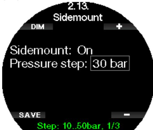
Wenn der Sidemount-Modus des Galileo 3 aktiviert ist [AN (ON)], werden zwei Flaschendrucke gleichzeitig angezeigt. Siehe Kapitel **Display-Konfiguration im Sidemount-Modus**, um mehr über die Konfiguration des Displays in diesem Modus zu erfahren.
