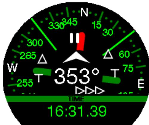
☞ **HINWEIS:** Verwende den Kompass des Galileo 3 nicht in der Nähe eines Magneten, da die magnetische Kraft dazu führen kann, dass die Kompasskalibrierung zurückgesetzt wird.
