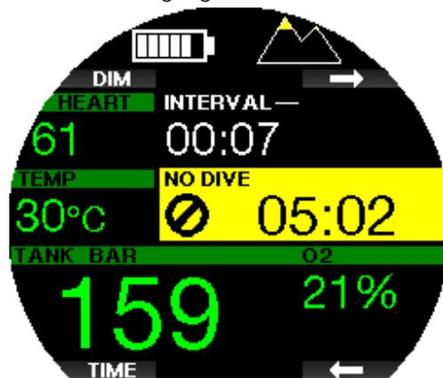
Sie sollten keinen Tauchgang unternehmen, solange die Tauchverbotswarnung auf dem Display des Tauchcomputers angezeigt wird. Wird die Warnung aufgrund der Mikroblasen-Ansammlung angezeigt (im Gegensatz zum ZNS O<sub>2</sub>-Stand über 40 %) und du tauchst trotzdem, werden die Nullzeiten verkürzt oder die Dekompressionszeiten verlängert. Zudem kann die Dauer der Mikroblasen-Warnung am Ende des Tauchgangs beträchtlich verlängert werden.
