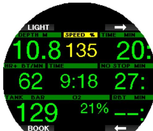
Bei Aufstiegsgeschwindigkeiten von über 140 % wird die Alarm **AUFSTIEG ZU SCHNELL!** (ASCENT TOO FAST) aktiviert und das Fenster wird rot.
