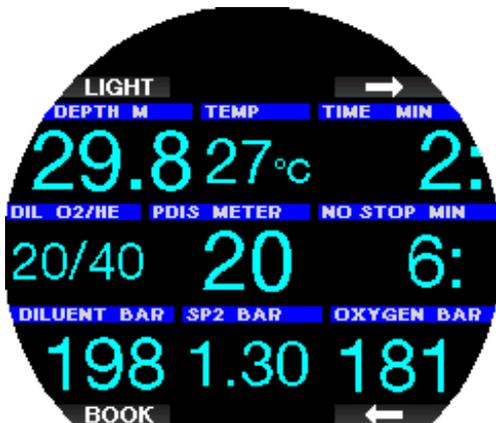
Der Setpoint zu Tauchbeginn (SP1) kann zwischen 0,2 bis 0,95 bar  $ppO_2$  eingestellt werden. Der Tiefen-Setpoint (SP2) hat einen Einstellbereich von 1,0 bis 1,6 bar  $ppO_2$ . Normalerweise wird er während des Abtauchens oder bei Erreichen der tiefsten Tiefe aktiviert. Die SP-Wechseltiefe wird vom Tauchcomputer auf dieselbe Art empfohlen, wie die Gaswechsel beim Tauchen mit offenem Kreislauf (vorausgeplanter
