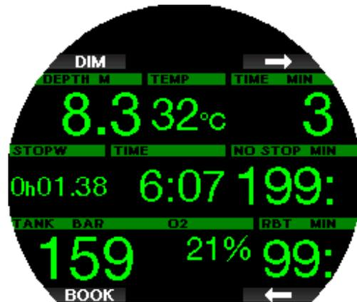
Zurücksetzen der Stoppuhr setzt ein Lesezeichen, das in LogTRAK auf dem Tauchprofil angezeigt wird.
