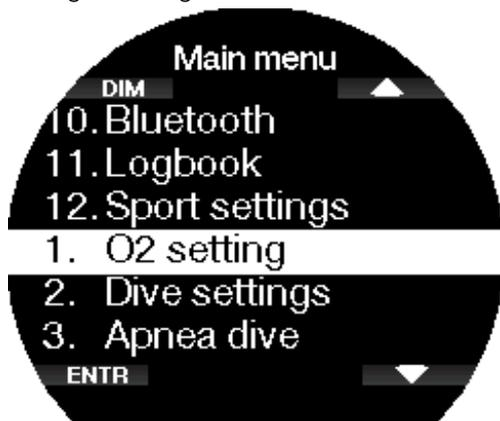
Mit den Pfeiltasten kannst du dich durch das Menü bewegen und mit ENTR gelangst du zur Menüauswahl. Unabhängig von der eingestellten Sprache, sind alle Menüs für eine einfache Identifizierung nummeriert. Auf ähnliche Weise wird für alle Untermenü-Funktionen bei einstellbaren Werten unten auf dem Display der mögliche Wertebereich angezeigt (siehe Display unten).
