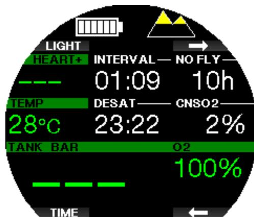
Die erlaubten Höhen werden mit dem Bergsymbol oben rechts auf dem aktuellen Taucheinstellungs-Display angezeigt. Die verbotenen Höhen (die nach den Berechnungen des Galileo 3 nicht kompatibel mit der aktuellen Stickstoffsättigung sind), sind die farbigen Segmente innerhalb des Bergsymbols. Weitere Informationen findest du im Kapitel Höhe und Dekompressionsalgorithmus.
