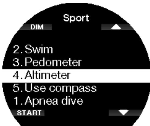
Wenn du deine aktuelle Höhe kennst, kannst du sie hier anpassen, indem du ANP (ADJ) drückst. Erhöhe oder verringere den Wert mit der oberen und unteren rechten Taste in Schritten von 10 m/30 ft. Mit SPEICHERN (SAVE) wird die eingestellte Höhe gespeichert.
