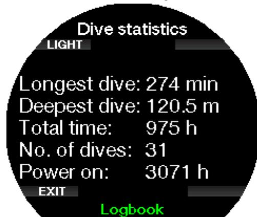
Hier werden Details wie längster und tiefster Tauchgang, Gesamttauchzeit und Anzahl der Tauchgänge angezeigt.
