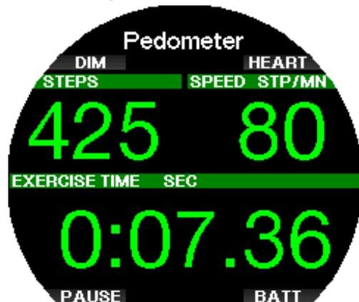
Mit der oberen und unteren rechten Taste kannst du die Informationen ändern, die im oberen linken Bereich des Displays angezeigt werden. Die folgenden alternativen Informationen können angezeigt werden:
