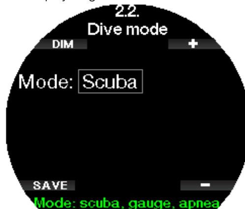
*HINWEIS: Da im Tiefenmesser- und im Apnoe-Modus keine Entsättigung berechnet wird, bleibt Galileo 3 nach dem letzten Tiefenmesser- oder Apnoe-Modus während 48 Stunden in einem Verriegelungsmodus, bevor wieder auf Scuba-Modus umgeschaltet werden kann. Umgekehrt wurde mit dem unten abgebildeten Galileo 3 in Scuba-Modus getaucht und der Tiefenmesser- oder Apnoe-Modus können erst aktiviert werden, nachdem die Entsättigungszeit abgelaufen ist.*
