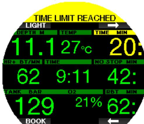
Wenn diese Warnung eingestellt ist, warnt dich Galileo 3 auch, wenn es Zeit ist, dich zur Oberfläche zu begeben. Die Meldung **UMKEHRZEIT** (TURN-AROUND TIME) wird angezeigt, wenn du die Hälfte der eingestellten Tauchzeitwarnung erreicht hast.
