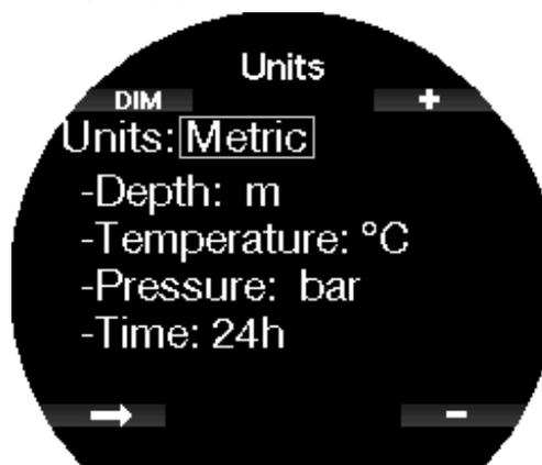
Wähle jede Einheit und schließlich das Zeitformat in 24 h- oder AM/PM-Format mit den +/- Tasten und bestätige mit der unteren linken Taste.
