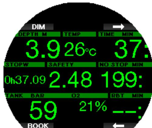
Der Sicherheitsstopp-Timer kann durch Drücken der Taste TIMER erneut zurückgesetzt werden.
