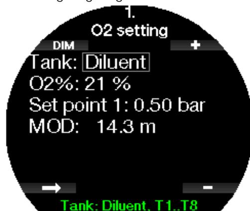
Andere Flaschen (T1 bis T8) können wie im PMG-Modus konfiguriert werden. Siehe Kapitel **CCR aktivieren**, um zu erfahren, wie diese Funktion aktiviert wird. Für Setpoint 1 kann ein Wert von 0,2 bis 0,95 bar ausgewählt werden, was die MOD bestimmt.
