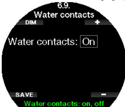
**HINWEIS:** Wenn die Wasserkontakte ausgeschaltet sind und du vergisst, den Computer von Hand einzuschalten, aktiviert er sich selbst innerhalb von einer Minute nach dem Start des Tauchgangs. Die Zeit und die Dekompressionsberechnungen werden jedoch ungenau sein. Die Genauigkeit der Tiefenmessung ist davon jedoch nicht betroffen.
