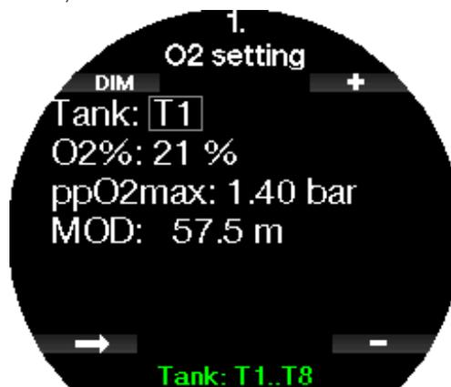
T1 ist immer das Gas am Anfang des Tauchgangs. Die Werte von Flasche 2 bis 8 können auf die gleiche Art wie Flasche 1 eingestellt werden. Du kannst für die Dekompressionsgase eine unterschiedliche ppO<sub>2</sub>-Einstellung verwenden.
