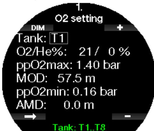
☞ **HINWEIS:** Um eine ausreichende Sauerstoffzufuhr zum Körper zu gewährleisten, muss das Gas am Anfang des Tauchgangs einen genügend hohen Sauerstoffgehalt aufweisen (du kannst ein „Travel-Mix“ oder eines der Dekompressionsgase verwenden). Da der Tauchgang immer mit Flasche T1 beginnt, ist die tiefstmögliche O<sub>2</sub>-Einstellung für die Flasche T1 18 %.
