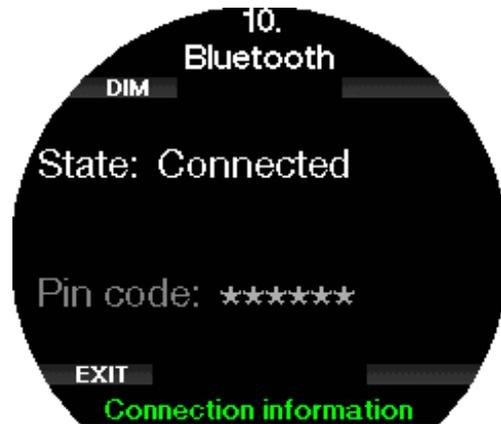
☞ *HINWEIS: Der Galileo 3 hat bei einer nicht aktiven Bluetooth-Verbindung eine Auszeit von 3 Minuten. Nach diesem Intervall wird der Galileo 3 Bluetooth deaktivieren und das Uhrendisplay erscheint, um Energie zu sparen.*
