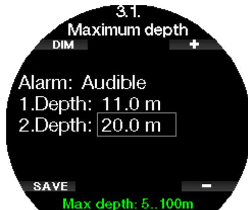
*HINWEIS: Der erste Alarm ist kurz, um die Aufmerksamkeit zu wecken, und der zweite Alarm ist kontinuierlich. Wenn der erste Alarm tiefer als der zweite gesetzt wird, wird er vom kontinuierlichen Alarm übertönt, und du kannst den ersten nicht hören.*
