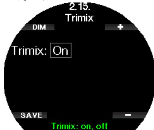
Wenn Trimix an ist, folgt die Darstellung der Gasgehalte dem Standard O<sub>2</sub>/He. Auch die AMD (absolute Minimaltiefe) für jedes Gas wird gezeigt. Siehe Kapitel **Tauchen mit Trimix-Modus**, um mehr über die Anwendung dieser Funktion zu erfahren.
