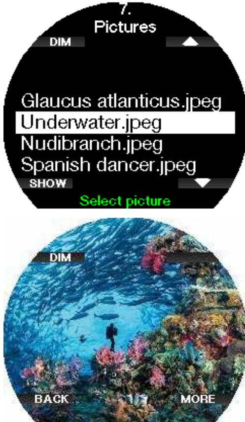
☞ **HINWEIS:** Profile, die Gewebesättigung und Bilder können für maximal 1 Minute angezeigt werden. Danach erscheint wieder das herkömmliche Tauchcomputer-Display. Wenn während der Anzeige eines Bildes eine Warnung oder ein Alarm ausgelöst wird, kehrt der Galileo 3 automatisch wieder auf das normale Tauchdisplay zurück.
