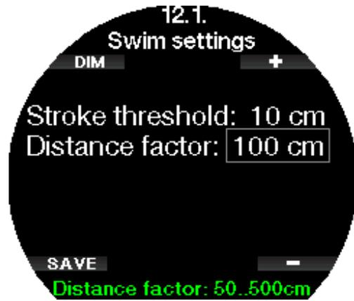
Für den Schwimmzugzähler musst du den Grenzwert des Schwimmzugzyklus (welche Tiefendifferenz soll als Schwimmzugzyklus erachtet werden) sowie die zurückgelegte Distanz pro Zyklus (Schwimmzuglänge) einstellen, um korrekte Ergebnisse zu erzielen. Die folgende Illustration zeigt die Parameter:
