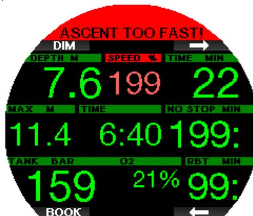
Galileo 3 bietet zudem einen akustischen Alarm, wenn die Aufstiegsgeschwindigkeit 110 % übersteigt: Die Intensität des Alarms nimmt in direkter Proportion mit dem Überschreiten der Aufstiegsgeschwindigkeit zu. Bei einem schnellen Aufstieg kann Galileo 3 bei Bedarf einen Dekompressionsstopp verlangen, auch wenn du innerhalb der Nullzeit tauchst, um die Bildung von Mikroblasen zu verhindern.
