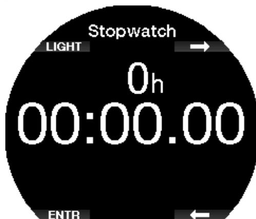
Mit START wird die Zeit gestartet, mit STOPP (STOP) wird sie angehalten.
