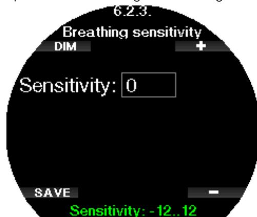
Wert 0 entspricht neutraler Atmungsempfindlichkeit. Mit dem Wert -12 hat Atmung den geringsten Effekt auf die Arbeitsleistung im Tauchalgorithmus.
