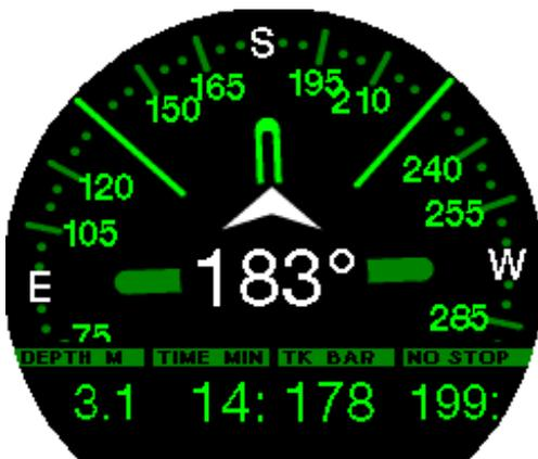
Bei erforderlichen Level-Stopps oder Dekompressionsstopps wird die Anzeige in der unteren rechten Ecke alle 4 Sekunden zwischen der Dekompressionsinformation und dem Flaschendruck zusammen mit der RBT wechseln.
