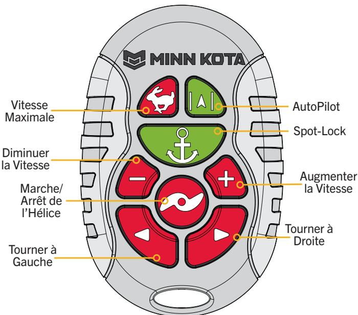
**AVIS :** Si le Spot-Lock Jog (déplacement du Spot-Lock) de votre moteur est activé, les fonctions des boutons Réduire la vitesse (vers l'arrière), Augmenter la vitesse (vers l'avant), Tourner à droite et Tourner à gauche passent au déplacement du bateau lorsque Spot-Lock est activé.
