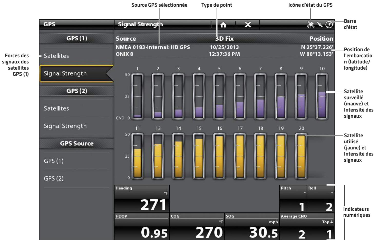
Intensité des signaux (GPS 1/GPS 2) : affiche des diagrammes à barres verticales indiquant les forces des signaux des satellites avec la valeur CNO (Porteuse/Bruit) respective (0 à 60).
