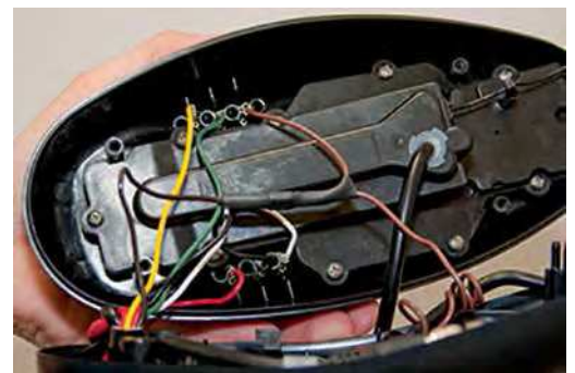
FIGURE 18 Insérez les fils d'AutoPilot dans les supports de terminaisons.
