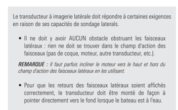
• Il ne doit y avoir AUCUN obstacle obstruant les faisceaux latéraux : rien ne doit se trouver dans le champ d'action des faisceaux (pas de coque, moteur, autre transducteur, etc.).
