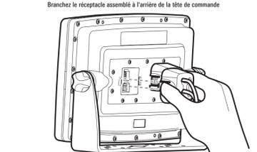
5. Le **montage sur cardan** : Remplacez la tête de commande sur le support de montage. Réglez la tête de commande en fonction de l'angle de vue désiré et attachez-le solidement en serrant les molettes du cardan.
