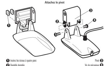
1 Insérez les écrous à quatre pans
