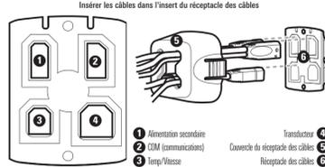
2. Alignez l'insert du réceptacle et le couvercle avec la fonction de déclenchement, puis insérez le couvercle en place sur l'insert.
