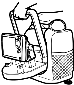
Installation de la base dans le boîtier
