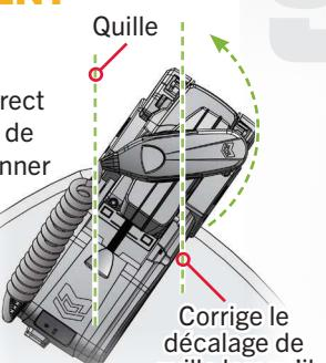
Le déploiement direct utilise le décalage de quille pour positionner l'unité inférieure parallèlement à la quille du bateau à chaque déploiement lorsqu'elle est engagée. Configurez-le depuis l'application One-Boat Network ou par la télécommande sans fil.
