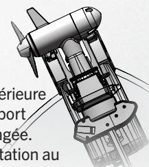
L'orientation au rangement est la direction dans laquelle l'unité inférieure repose sur le support lorsqu'elle est rangée. Configurez l'orientation au rangement à Hélice à droite ou Hélice à gauche (par défaut) depuis l'application One-Boat Network ou par la télécommande sans fil.
