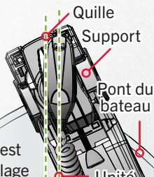
Le moteur de pêche à la traîne est livré avec le décalage de quille parallèle au support du moteur. Pour un contrôle adéquat, tournez le moteur parallèlement à la quille du bateau et réglez le décalage de quille. Enregistrez le décalage de quille par l'intermédiaire de la télécommande sans fil ou de l'application One-Boat Network.
