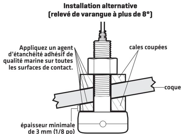
1. Depuis l'extérieur de la coque, percez un petit trou de guidage [plus petit que la pointe de centrage de votre perceuse ou scie-cloche] à l'emplacement de montage sélectionné à la section 2. **Percez le trou perpendiculairement à la ligne de flottaison.**
