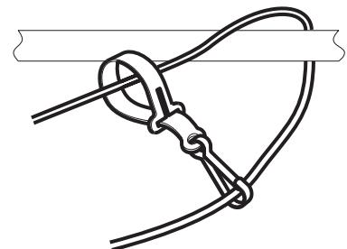
Fixez une sangle au câble du transducteur et enroulez le câble autour d'un objet fixe comme une rambarde ou tout autre accessoire de fixation, conformément à l'illustration [voir **Sangle d'attache du transducteur**].
