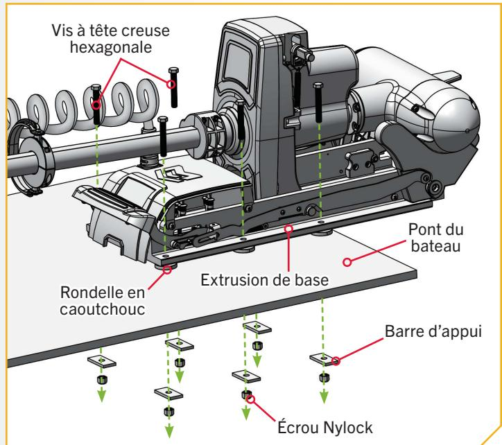
**AVIS :** Faites preuve de vigilance pour éviter de pincer ou d'endommager les fils de capteur qui longent l'extrusion de base lors de l'installation et du serrage de la quincaillerie de montage.
