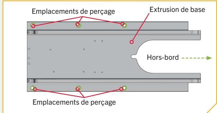
**AVIS :** La surface de montage du Riptide Terrova QUEST doit être plate. Des rondelles en caoutchouc peuvent être utilisées pour caler l'extrusion de base afin qu'elle soit à plat avant le serrage de la quincaillerie.
