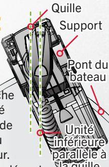
Le moteur de pêche à la traîne est livré avec le décalage de quille parallèle au support du moteur. Pour un contrôle adéquat, tournez le moteur parallèlement à la quille du bateau et réglez le décalage de quille. Enregistrez le décalage de quille par l'intermédiaire de la télécommande sans fil ou de l'application One-Boat Network.
