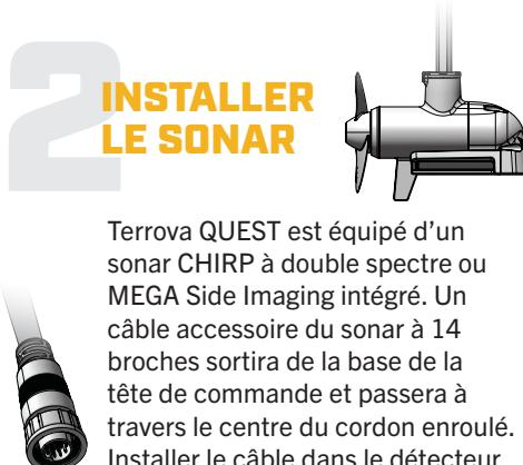
Terrova QUEST est équipé d'un sonar CHIRP à double spectre ou MEGA Side Imaging intégré. Un câble accessoire du sonar à 14 broches sortira de la base de la tête de commande et passera à travers le centre du cordon enroulé. Installer le câble dans le détecteur de poissons.
