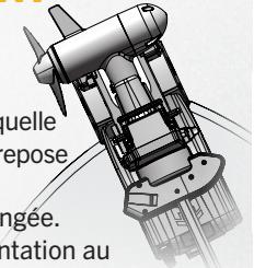
L'orientation au rangement est la direction dans laquelle l'unité inférieure repose sur le support lorsqu'elle est rangée. Configurez l'orientation au rangement à Hélice à droite ou Hélice à gauche (par défaut) depuis l'application One-Boat Network ou par la télécommande sans fil.
