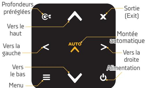
**ALIMENTATION :** lorsque le treuil est en « arrêt » (off) appuyer pour mettre le treuil en « marche » (on). Lorsque le treuil est en « marche » (on), une poussée rapide ouvrira le menu d'alimentation. Appuyer et tenir pour trois secondes mettra le treuil en « arrêt » (off).
