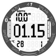
Al igual que en el modo Gauge, A1 no realiza ningún cálculo de descompresión en el modo Apnea. Solo podrá cambiar al modo APNEA si el ordenador está completamente desaturado. Además, en el modo APNEA A1 se bloquea durante 12 horas tras inmersiones a menos de 5 m de profundidad y durante 24 horas tras inmersiones más profundas.
