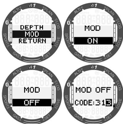
La alarma MOD emplea el valor de  $ppO_2$  máxima que se obtiene en los ajustes de gas y el valor predeterminado es 1,4 bar.
