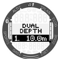
Ambas alarmas de profundidad se pueden definir entre 5 y 100 m (20 y 330 ft) con incrementos de 1 m/5 ft pulsando los botones +/UP o -/DOWN. Pulsando el botón SEL/ESC, confirmará el primer valor y la segunda profundidad puede ajustarse.
