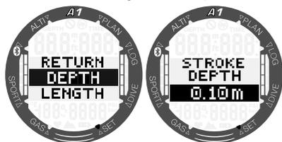
Si pulsa el botón SEL/ESC, regresará al submenú anterior, en el que podrá navegar hasta los ajustes de longitud de la patada. Puede seleccionar el valor entre 0,5 m/2 ft y 5,0 m/16 ft pulsando los botones +/UP o -/DOWN. Confirme sus ajustes pulsando el botón SEL/ESC.
