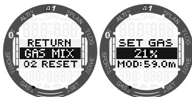
👉 **NOTA:** El ajuste de la mezcla gaseosa estará deshabilitado si el modo de inmersión seleccionado es Apnea o Gauge.
