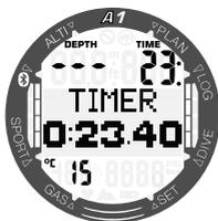
Durante una inmersión en el modo GAUGE, A1 muestra la profundidad y el tiempo de inmersión en la fila superior, un temporizador en el centro y la temperatura del agua en la fila inferior. El temporizador se puede pausar y reiniciar manteniendo pulsado el botón +/UP. Cuando se pause el cronómetro, se puede poner a cero manteniendo pulsado el botón -/DOWN. Puede navegar por las pantallas alternativas del centro pulsando los botones +/UP o -/DOWN.
