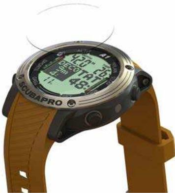
**NOTA:** Si quedan atrapadas burbujas de aire debajo del protector cuando lo coloque sobre la superficie de cristal de A1, no intente eliminarlas porque la presión del agua las eliminará tras la primera inmersión.
