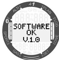
Tras finalizar la actualización, A1 mostrará el mensaje "Software OK". Este mensaje se puede borrar pulsando brevemente el botón SEL/ESC. Una vez finalizado este proceso, A1 volverá a estar listo para el uso normal.
