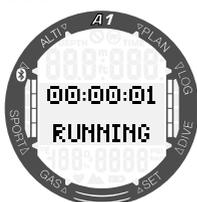
Para detener el tiempo en el cronómetro, vuelva a pulsar el botón +/UP. Para restablecer el tiempo a 0, mantenga pulsado el botón +/UP mientras la pantalla del cronómetro muestra el estado STOPPED.
