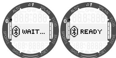
Para establecer la comunicación con otro dispositivo mediante Bluetooth, active el modo Scanning (Exploración) en el dispositivo con el que desee que A1 se comunique (por ejemplo, un dispositivo iOS o Android).
