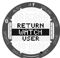
Desde el menú **Settings** (Ajustes) navegue hasta **Watch** (Reloj) y pulse SEL/ESC.
