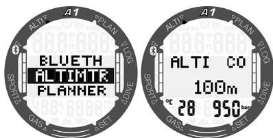
Desde el menú principal, navegue hasta el menú **Altimtr (Altimetro)** y pulse el botón SEL/ESC para acceder. En el menú **Altimtr (Altimetro)**, en la primera pantalla se calcula la altitud actual (en metros o pies) a partir de la presión barométrica y se muestra en el centro de la pantalla. La temperatura (en grados centígrados o Fahrenheit) y la presión del aire (en mbar) de su altitud actual se muestran en la parte inferior izquierda e inferior derecha de la pantalla, respectivamente.
