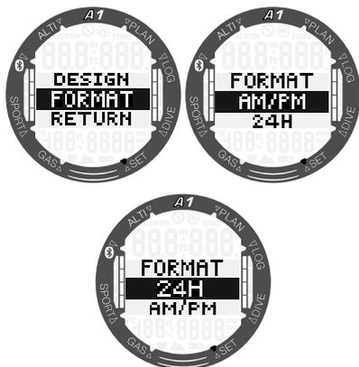
**NOTA:** El formato de la hora también cambiará el formato de la fecha: MM/DD/YY en el modo AM/PM y DD/MM/YY en el modo 24h. Este cambio tendrá lugar, por ejemplo, en los modos del reloj, diario de inmersiones, etc.
