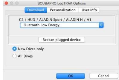
**NOTA:** A1 tiene un tiempo de espera de inactividad 5 minutos para las conexiones Bluetooth. Después de este intervalo, A1 deshabilitará el Bluetooth y regresará al modo de hora y fecha.
