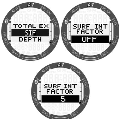
Puede definir el SIF entre 5 y 20 o deshabilitarlo con el ajuste OFF pulsando los botones +/UP o -/DOWN y pulsando el botón SEL/ESC a continuación para guardar.
