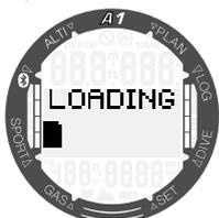
Tras descargar el software correctamente, A1 comenzará a reprogramarse automáticamente.
