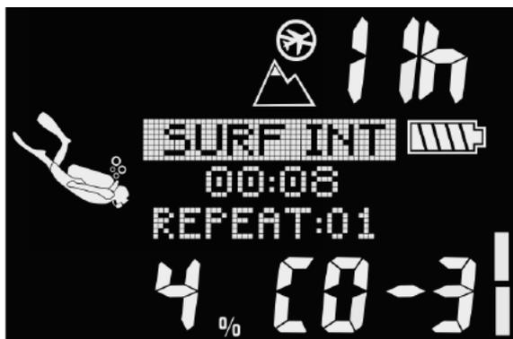
El reloj de CNS  $O_2$  aumenta cuando la presión parcial de oxígeno es superior a 0,5 bar y disminuye cuando la presión parcial de oxígeno es inferior a 0,5 bar. Por tanto, mientras esté respirando aire en la superficie, el reloj de CNS  $O_2$  disminuirá siempre. Durante la inmersión, la profundidad a la que se alcanzan los 0,5 bar con distintas mezclas es la siguiente:
