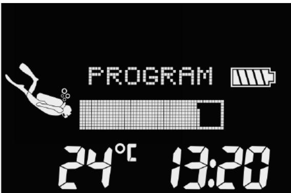
☞ **NOTA:** LUNA 2.0 comprobará estado de la pila antes del proceso de actualización. Si el nivel de la pila es demasiado bajo, no será posible iniciar la actualización de software. Para actualizar LUNA 2.0, antes debe sustituir la pila.
