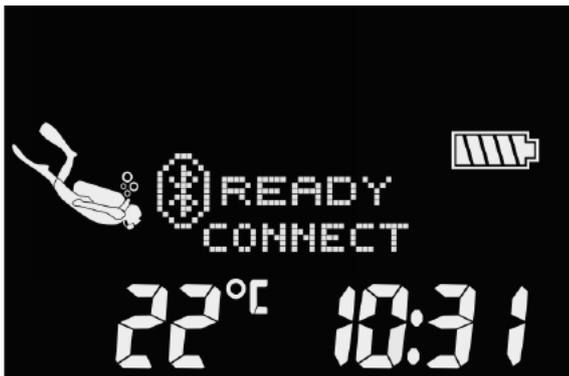
☞ *NOTA: LUNA 2.0 tiene un tiempo de espera de inactividad de 3 minutos para las conexiones Bluetooth. Una vez transcurrido este tiempo, LUNA 2.0 deshabilitará la función Bluetooth y regresará a la pantalla de superficie para ahorrar energía.*
