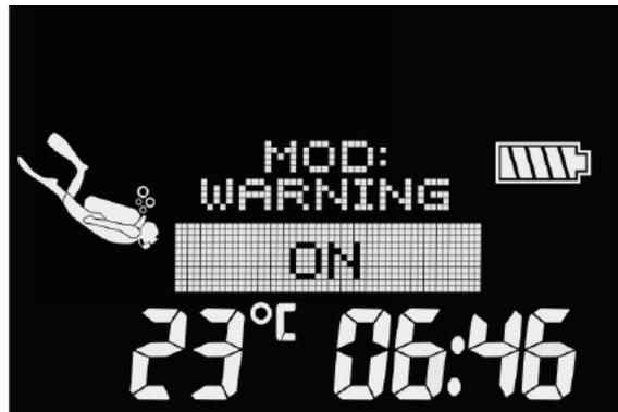
La alarma MOD emplea el valor de  $ppO_2$  máxima que se obtiene en los ajustes de gas y el valor predeterminado es 1,4 bar.
