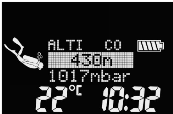
☞ *NOTA: La presión barométrica es una variable que cambia con el clima y con la presión atmosférica a esa elevación. El algoritmo de inmersión emplea clases de altitud que derivan directamente de la presión barométrica. La altitud se contabiliza desde la presión barométrica actual, por lo que es un valor relativo.*
