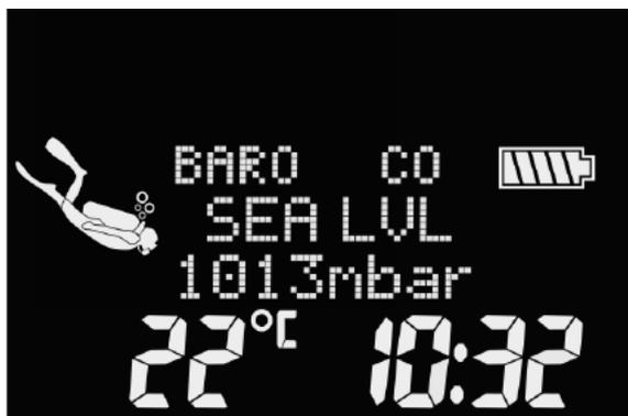
La función de barómetro le permite prever la meteorología de las próximas horas si mantiene la misma altitud.
