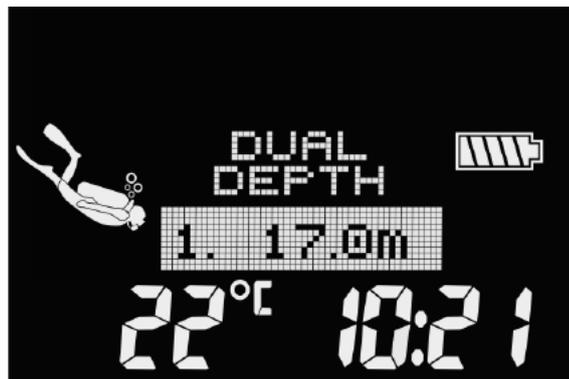
Ambas alarmas de profundidad se pueden definir entre 5 y 100 m (20 y 330 ft) con incrementos de 1 m/5 ft. Manteniendo pulsado el botón derecho, confirmará el primer valor y podrá ajustar la segunda profundidad.
