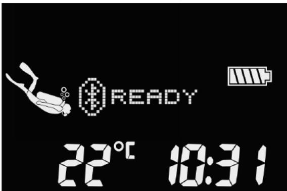
Para establecer la comunicación con otro dispositivo mediante Bluetooth, ajuste en modo "Scanning" (Exploración) el dispositivo con el que desee que LUNA 2.0 se comunique (por ejemplo, un dispositivo portátil iOS® o Android™). La primera vez que realice esta operación, deberá introducir un código de seguridad para garantizar una comunicación segura. Este código de seguridad lo genera LUNA 2.0 de forma aleatoria y se muestra en la pantalla.
