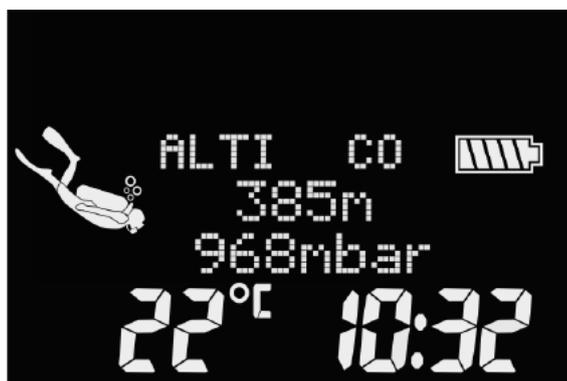
La altitud se puede ajustar si se conoce la elevación actual. Manteniendo pulsado el botón derecho, el valor de la altitud del centro de la pantalla se puede ajustar en incrementos de 5 m/16 ft.
