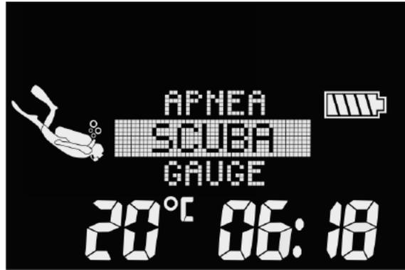
☞ **NOTA:** Los modos GAUGE y APNEA no realizan ningún seguimiento de la saturación tisular, por eso hay un intervalo de "bloqueo" antes de que sea posible realizar el cambio al modo SCUBA. En el modo GAUGE, el intervalo de bloqueo es de 48 h tras la última inmersión. En el modo APNEA, existe un intervalo de bloqueo de 12 h con inmersiones a una profundidad inferior a 5 m/16 ft y un intervalo de bloqueo de 24 h con inmersiones a una profundidad superior a 5 m/16 ft.
