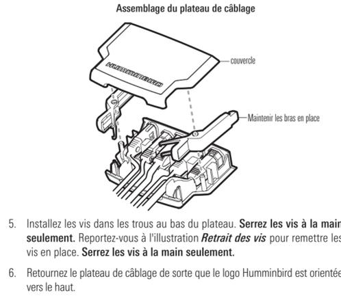
Vérifiez les câbles pendent droite, et les détordre si nécessaire.
