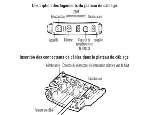
**⚠ MISE EN GARDE!** Il est important de placer les connecteurs dans les bons logements avec le bon côté orienté vers le haut. Reportez-vous à l'illustration ***Description des logements du plateau de câblage*** pour plus de détails.
