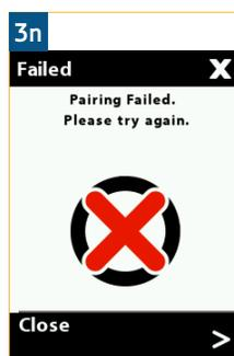
**AVIS :** le treuil demeure en mode de jumelage pendant 30 secondes. Si le code d'autorisation est envoyé à l'appareil mobile, mais qu'il n'est pas confirmé, le jumelage va échouer. Réessayez le jumelage et veillez à confirmer le code d'autorisation avant la temporisation du jumelage.
