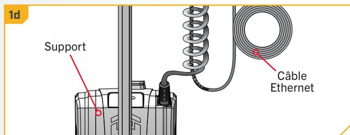
**AVIS :** Minn Kota recommande de faire passer le câble Ethernet par le cordon enroulé. Il n'est pas recommandé de contourner le cordon enroulé lors de l'acheminement du câble Ethernet.
