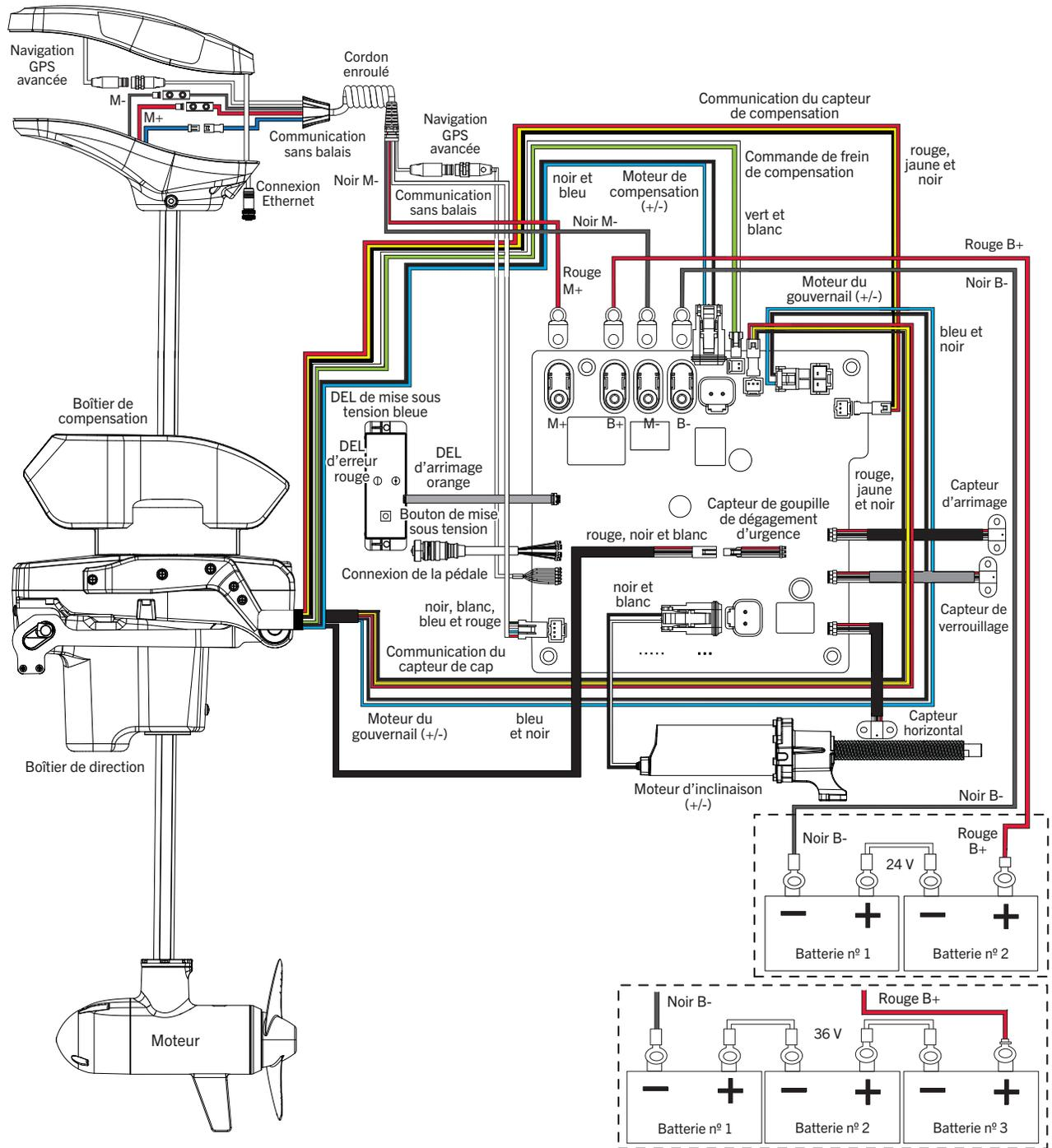
**AVIS :** il s'agit d'un schéma multitenion. Revérifiez la tension de votre moteur afin d'effectuer les raccordements appropriés. Les dispositifs de protection contre les surintensités ne figurent pas dans cette illustration.
