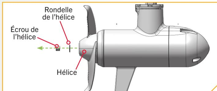
**AVIS:** Si l'ergot d'entraînement est cisailé ou cassé, tenez l'arbre d'armature stable à l'aide d'un tournevis à lame plate enfoncé dans la fente à l'extrémité de l'arbre pendant que vous desserrez l'écrou de l'hélice.
