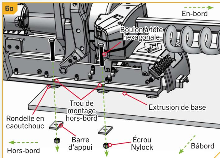
**AVIS :** Faites preuve de vigilance pour éviter de pincer ou d'endommager les fils de capteur qui longent l'extrusion de base lors de l'installation et du serrage de la quincaillerie de montage.
