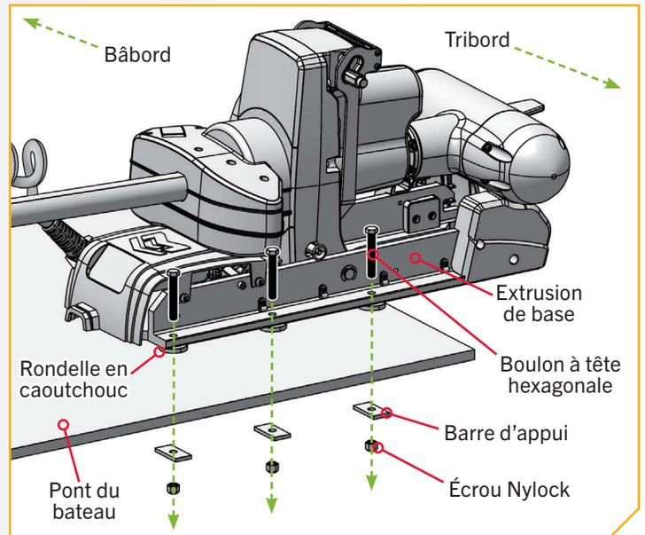
**AVIS :** Faites preuve de vigilance pour éviter de pincer ou d'endommager les fils de capteur qui longent l'extrusion de base lors de l'installation et du serrage de la quincaillerie de montage.
