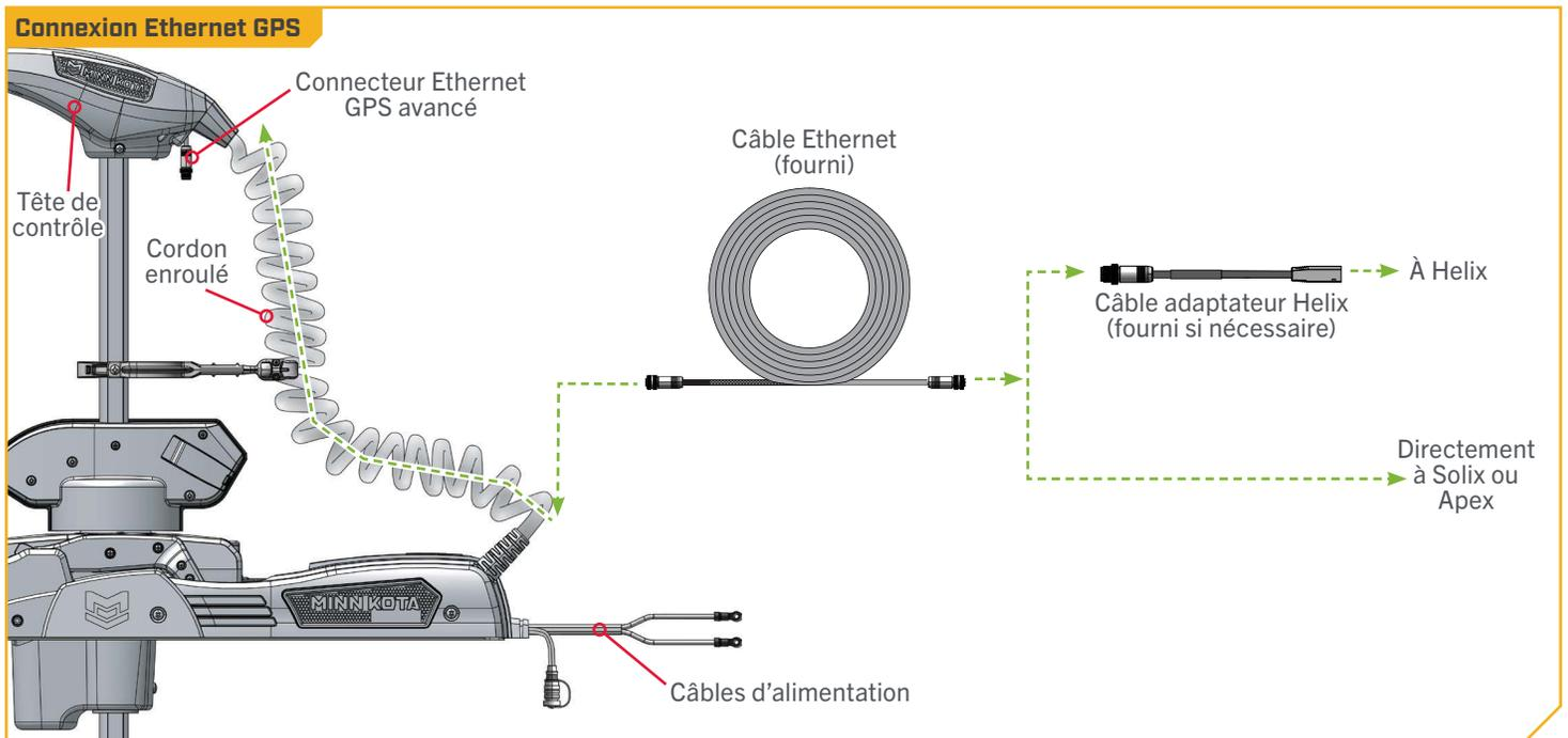
**AVIS :** Minn Kota recommande de faire passer le câble Ethernet ou la rallonge Ethernet à travers le cordon enroulé lors de la connexion Ethernet. Les câbles sont installés du support à la tête de contrôle via le cordon enroulé. Il n'est pas recommandé de contourner le cordon enroulé lors de l'acheminement du câble Ethernet ou de la rallonge Ethernet.
