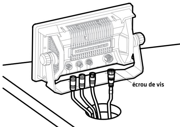
6. Puis branchez-les sur les connecteurs appropriés de la tête de commande. Les ports sont étiquetés et les connecteurs de câbles sont également marqués afin d'éviter toute erreur d'installation.
